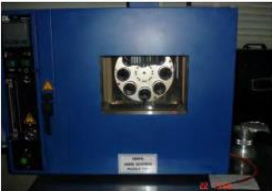
HORNO ROTATORIO PARA ENSAYO DEL EFECTO DE CALOR Y AIRE A 163°C
