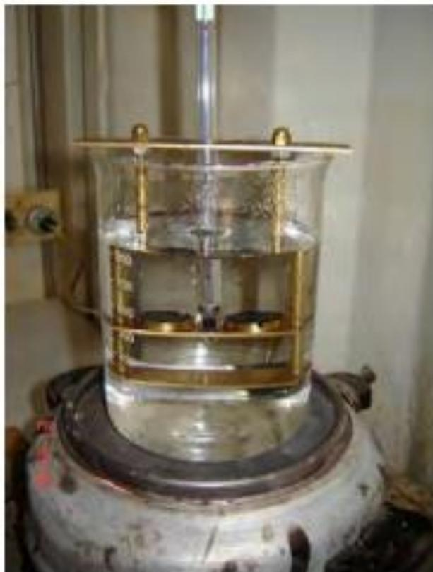
APARATO DE ANILLO Y ESFERA PARA ENSAYO DE PUNTO DE ABLANDAMIENTO
