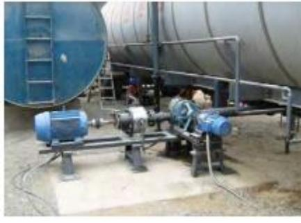
MOLINO COLOIDAL Y BOMBA DE ASFALTO
