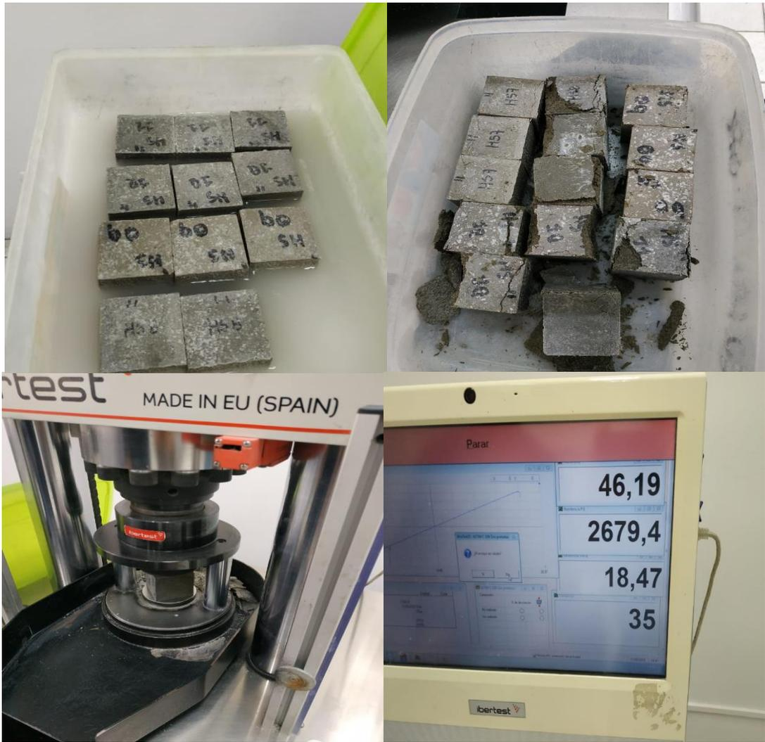
**Figura 33.** Ensayo de resistencia a la compresión en probetas de mortero (IAP)
