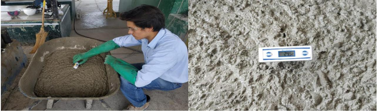
**Figura 39.** Ensayo de determinación de temperatura en el concreto
