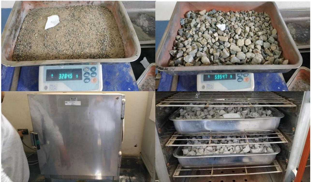
**Figura 34.** Ensayo de contenido de humedad de piedra zarandeada H57 y arena natural
