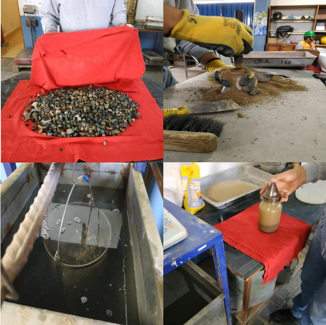
**Figura 37.** Ensayo de peso específico de piedra zarandeada H57 y arena natural
