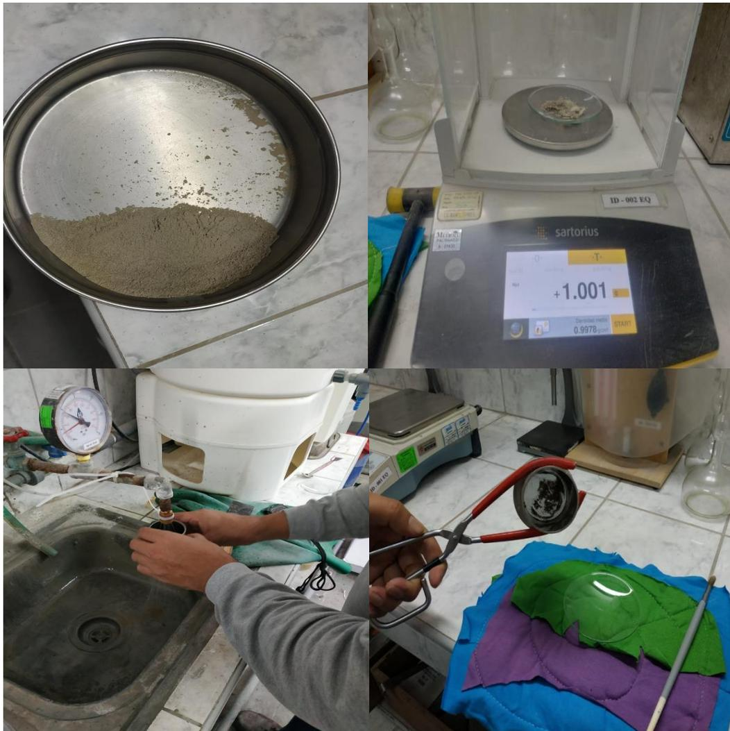
**Figura 32.** Ensayo de retenido en malla %325 por vía húmeda
