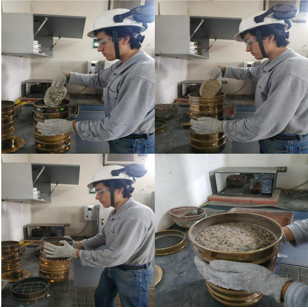
**Figura 35.** Ensayo granulométrico de piedra zarandeada H57 y arena natural
