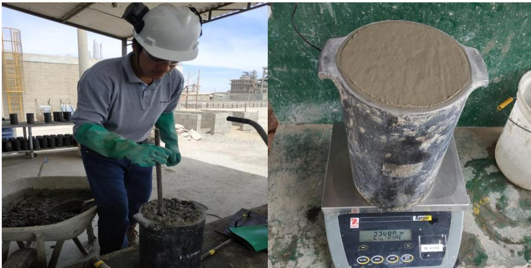
**Figura 40.** Ensayo de peso unitario del concreto
