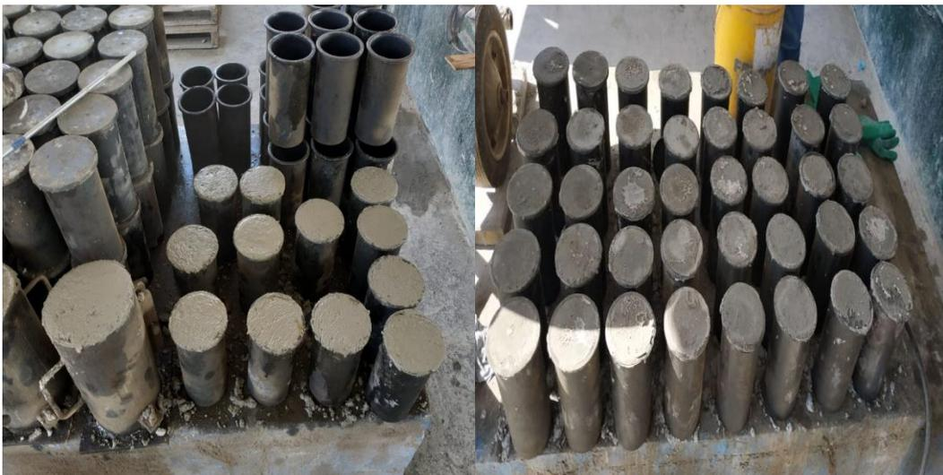
**Figura 42.** Elaboración de probetas cilíndricas de concreto
