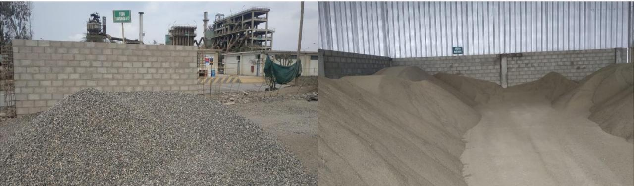
Figura 30. Pilas de agregado grueso y agregado fino
