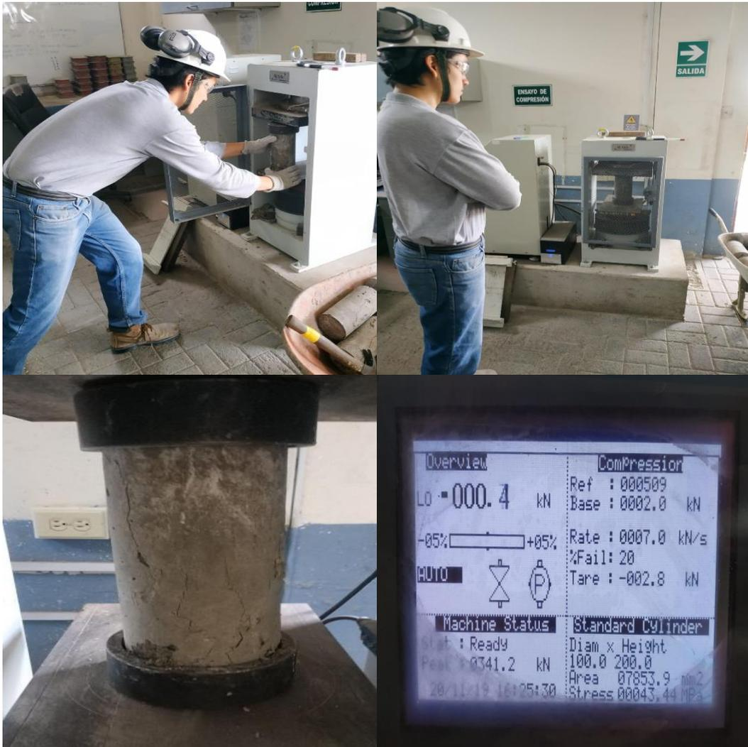
**Figura 44.** Ensayo de resistencia a la compresión
