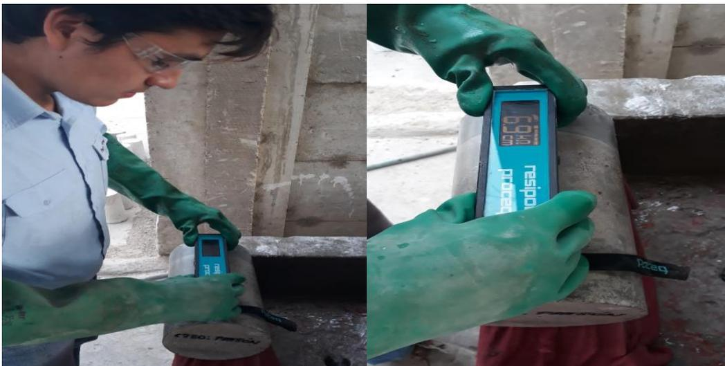
Figura 47. Ensayo de resistividad eléctrica
