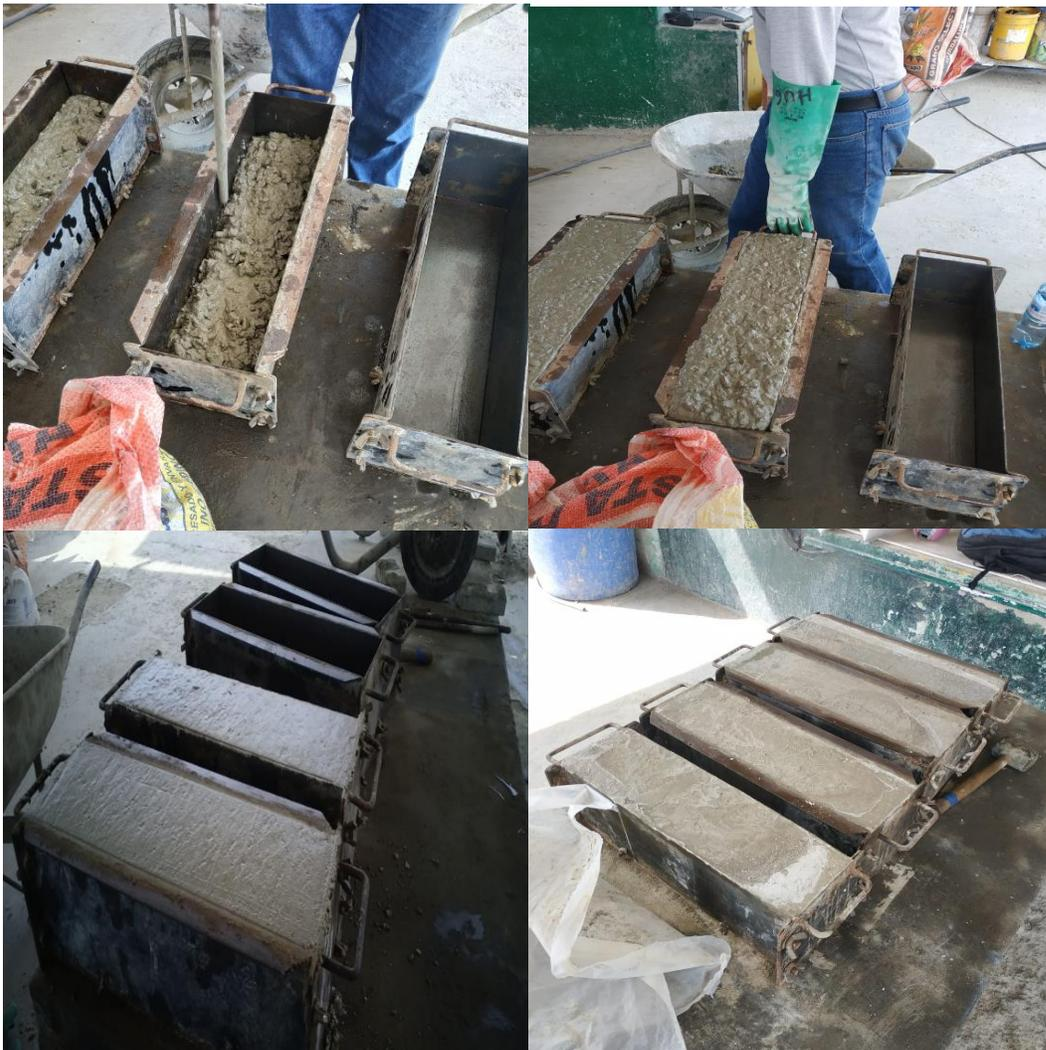
**Figura 43.** Elaboración de probetas prismáticas de concreto
