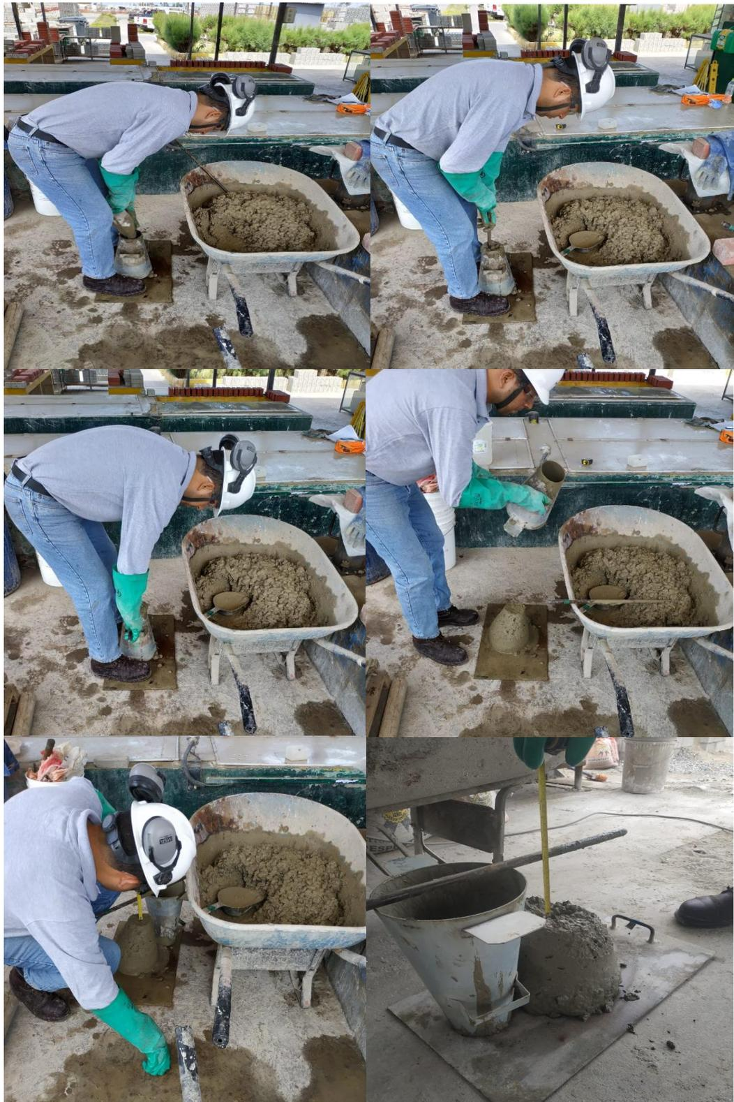
**Figura 38.** Ensayo de determinación de asentamiento del concreto
