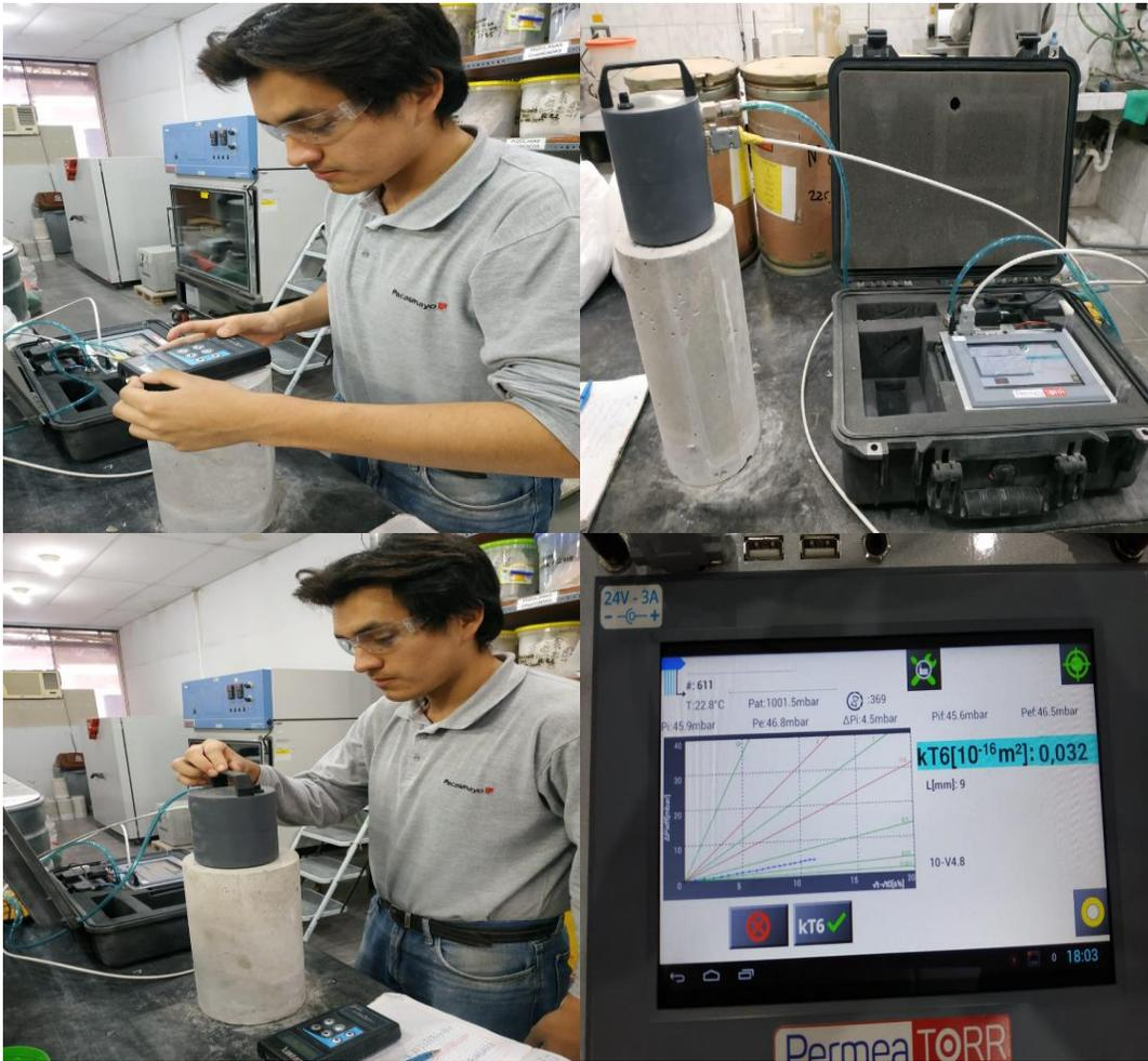
Figura 46. Ensayo de permeabilidad al aire
