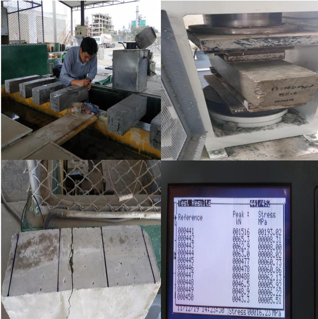
Figura 45. Ensayo de resistencia a la flexión
