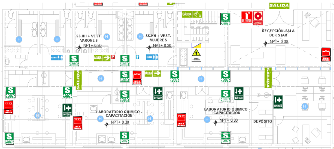
Figura 68: Planta de señalización – Laboratorio multipropósito
