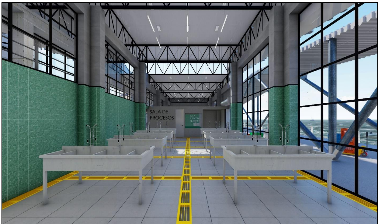
Imagen 13 – Rejillas en sala de lavado. Fuente: Elaboración propia.
