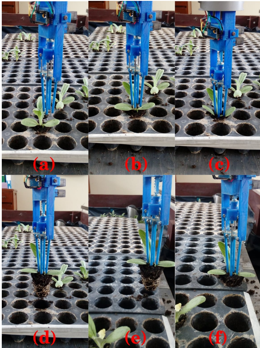
Figura 45: Uso de la herramienta gripper durante el proceso de repique: (a) Gripper durante posicionamiento; (b) Gripper posicionado; (c) Gripper cogiendo plantín; (d) Plantín levantado; (e) Plantín trasladado a bandeja final; (f) Plantín repicado. Fuente: Elaboración propia
