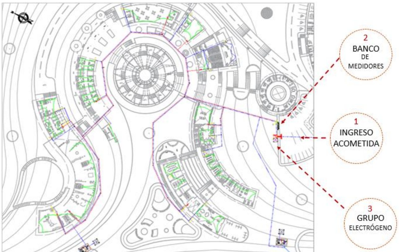
Plano N°36: Plano General de Instalaciones Eléctricas
