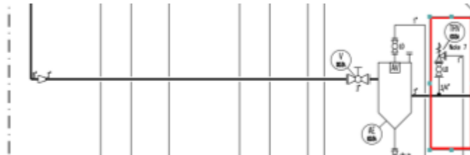
Imagen 50: Válvula TPRV en el Stream 3.
