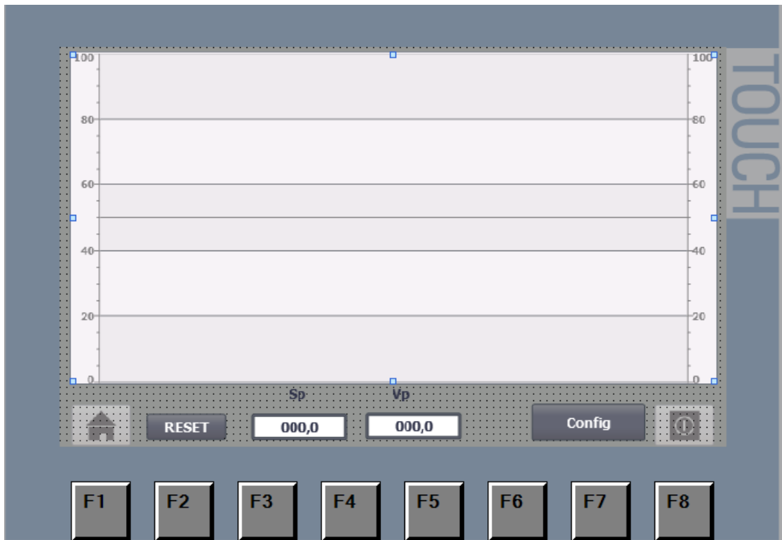
Figura 38 Pantalla Principal del HMI. Fuente Elaboración propia
