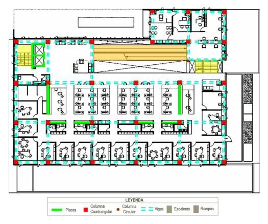
Ilustración 66. Elementos Estructurales (Primer Nivel)
