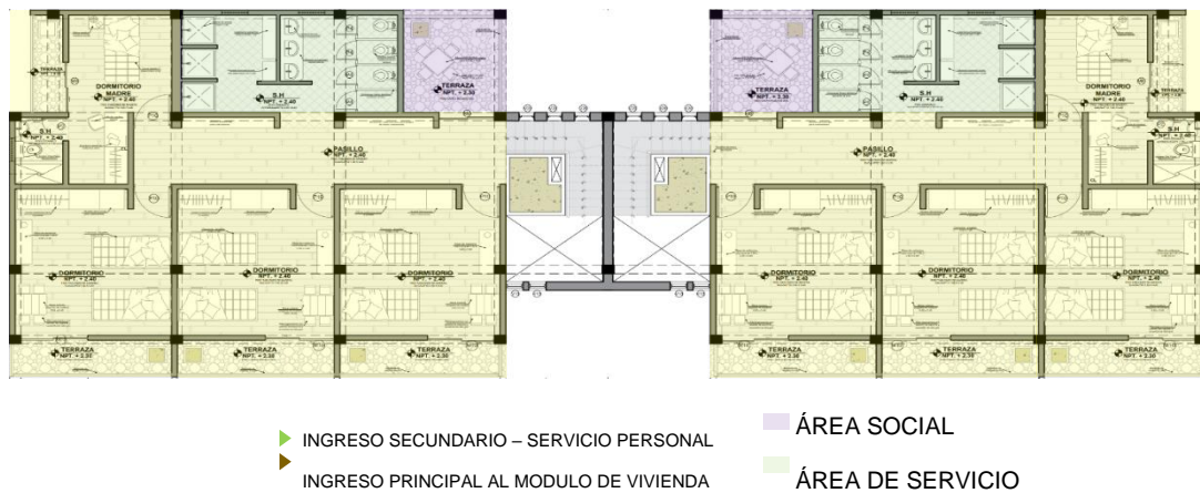
Ilustración 79 Plano de distribución del segundo nivel
