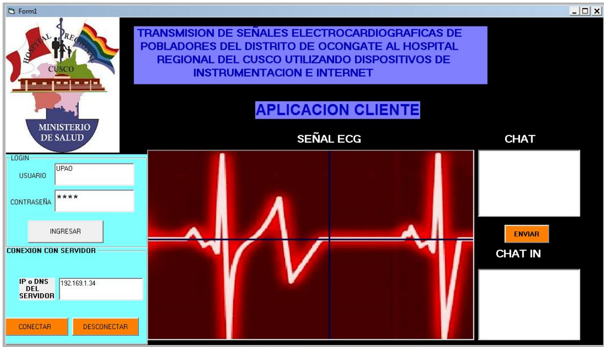
Figura 44. Interfaz HMI para visualización de la señal electrocardiográfica del cliente.
