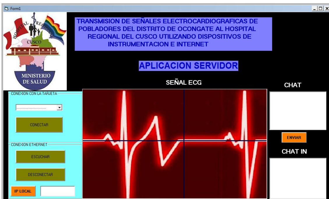
Figura 43. Interfaz HMI para visualización de la señal electrocardiográfica en el Servidor.
