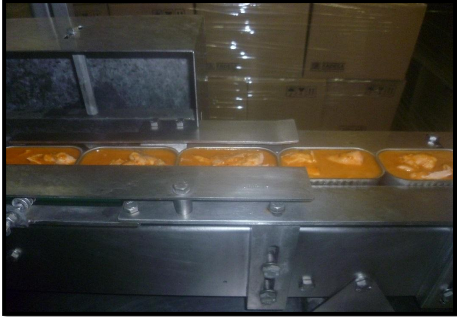
Figura P. Latas en proceso de sellado
