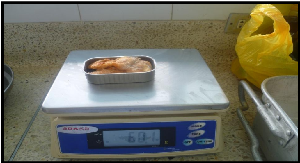
Figura K. Llenado y pesado de los recortes de filete de trucha a los envases de hojalata ¼ club
