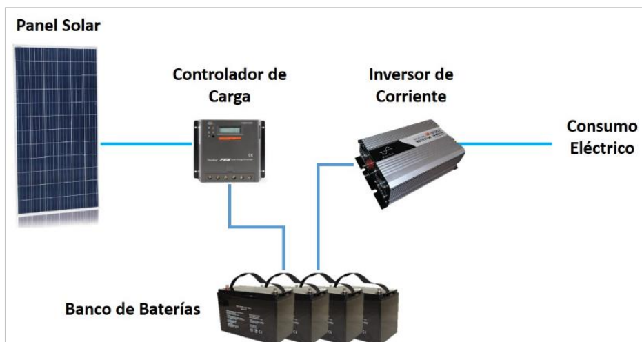
FIGURA 55: ESQUEMA DE INSTALACIÓN DE PANEL SOLAR
