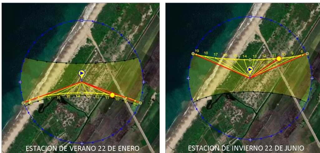
FIGURA 38: SIMULACIÓN DE RAYOS SOLARES EN EL TERRENO.
