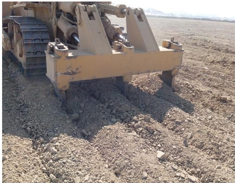
Figura 8. Subsulado de lotes con tractor oruga.
