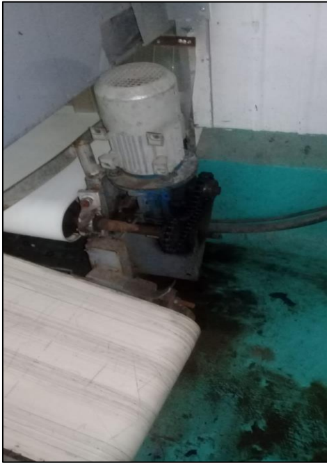
Gráfico 23. Motor con exceso de lubricante.
