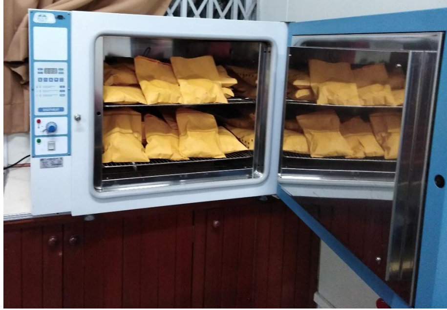
Figura 23: Sobre con raíces extraídas de cada tratamiento en la estufa para el cálculo de peso seco.
