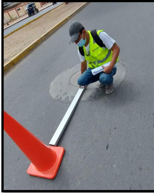
*Figura C21.* Abultamiento y hundimiento de nivel de severidad baja localizada en la unidad de muestra UM 23, tramo II
