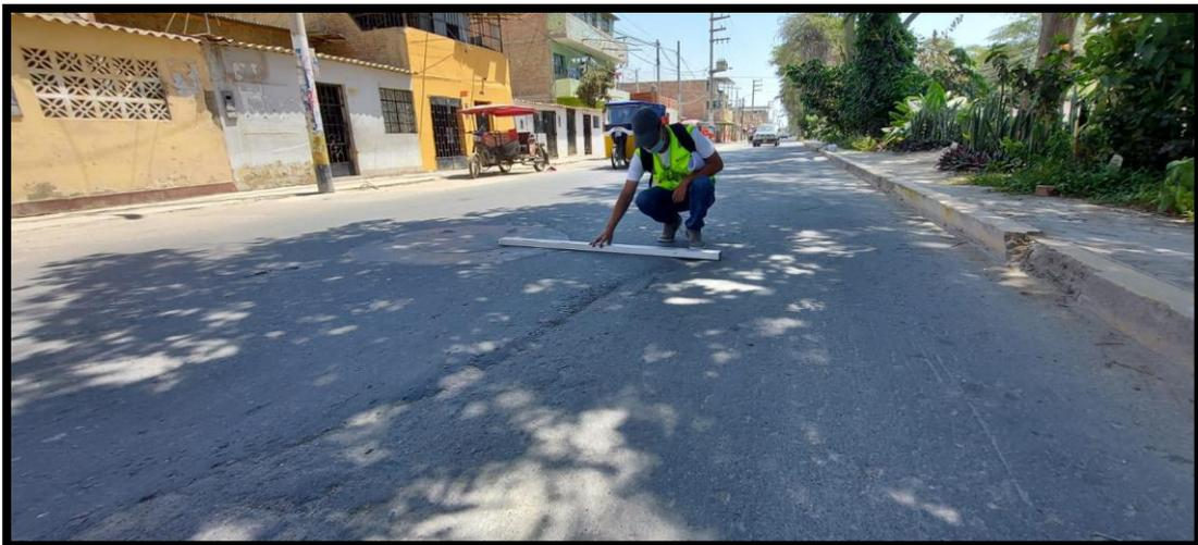
*Figura C29.* Abultamiento y hundimiento de nivel de severidad baja localizada en la unidad de muestra UM 31, tramo II
