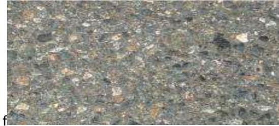
*Figura 20. Pulimiento de agregado*
