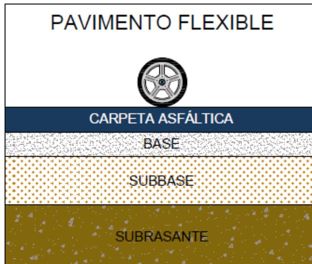
*Figura 1. Paquete estructural de un pavimento flexible*
