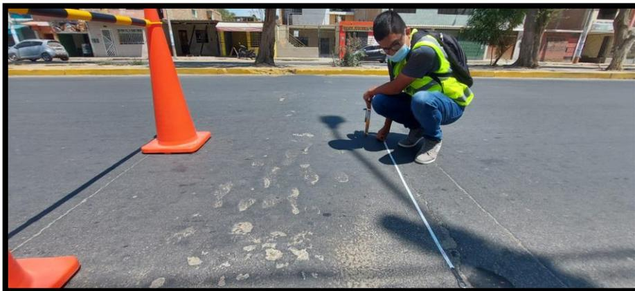
*Figura C2.* Fisuras de nivel de severidad baja localizada en la unidad de muestra UM 01, tramo I
