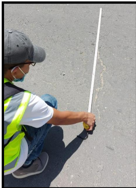
*Figura C24.* Fisuras de nivel de severidad baja localizada en la unidad de muestra
