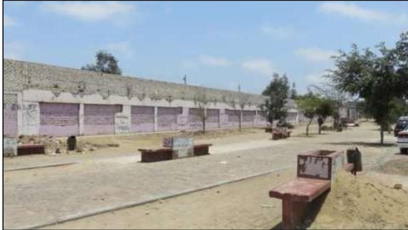
No se observa elementos de protección en los cambios de nivel, asimismo el muro de contención entre plataformas, no es de concreto, solo presenta un muro de piedra e hileras de ladrillo; asimismo la transición entre niveles no es equidistante a todos los sectores del nivel secundario, no se observa escalinatas o rampas.
