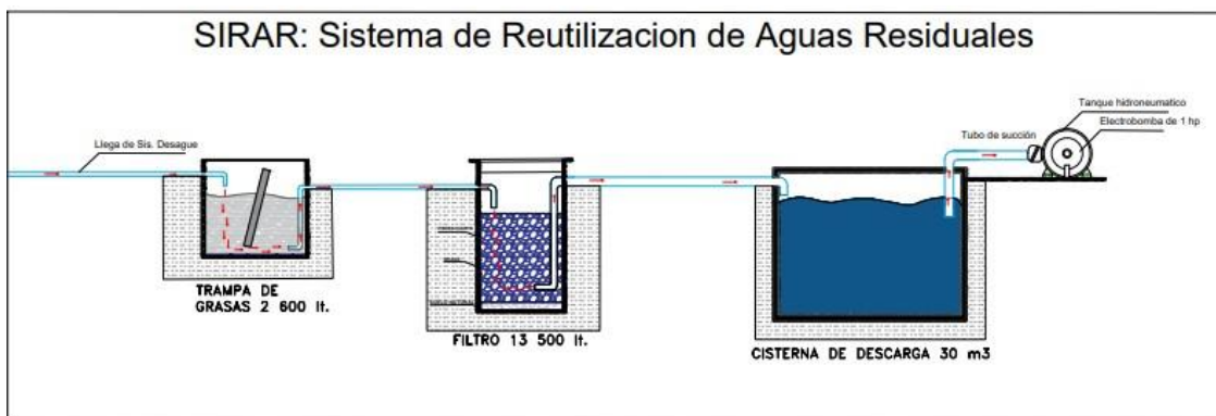
Ilustración 62: SISTEMA SIRAR (Sistema Integral de Reutilización de Aguas Residuales)
