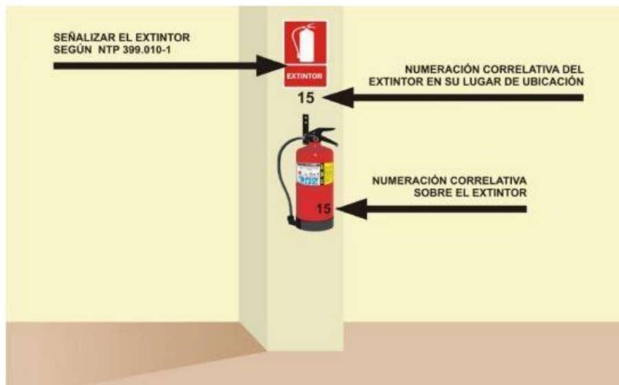
Ilustración 68:SEÑALIZACION DEL EXTINTOR
