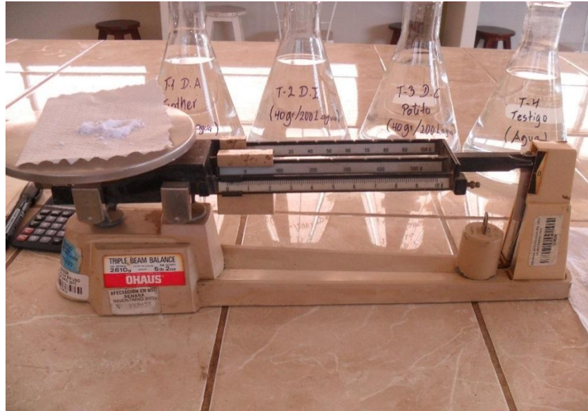
Figura 10. Balanza de triple brazo utilizada para medir las concentraciones de los detergentes utilizados en condiciones de laboratorio.
