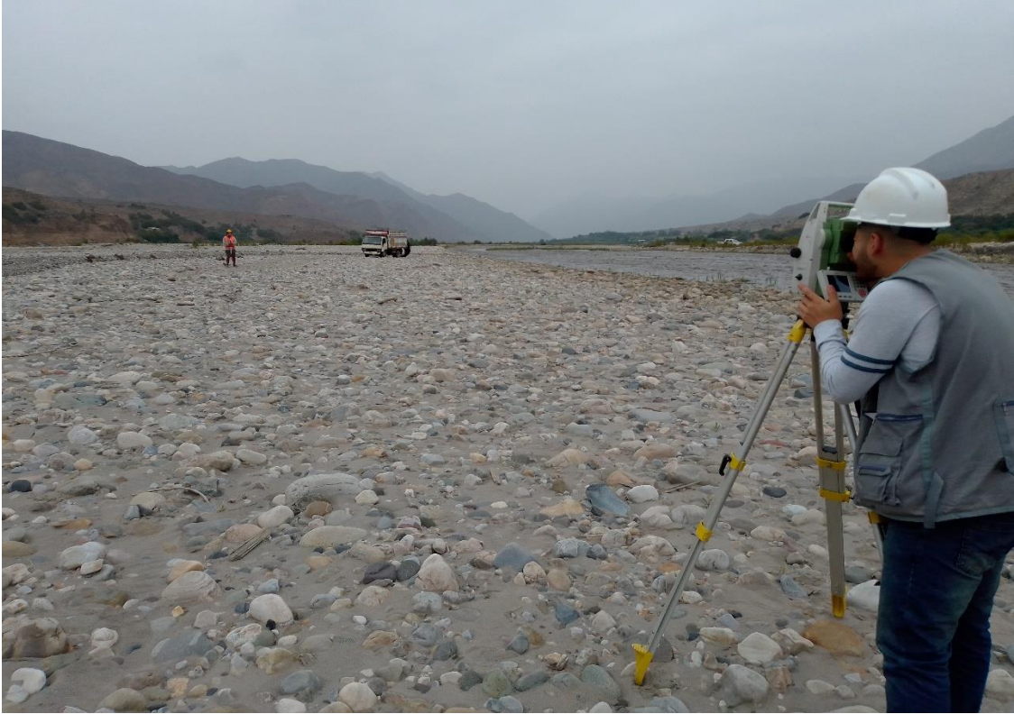
Fotografía 3: Se aprecia en la imagen el levantamiento topográfico en el lecho de río Chicama en el tramo el Algarrobo.
