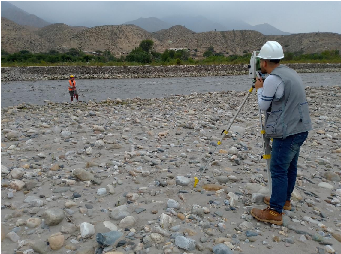
Fotografía 4: Se aprecia en la cuarta imagen el levantamiento topográfico en el lecho de río Chicama en el tramo el Algarrobo.
