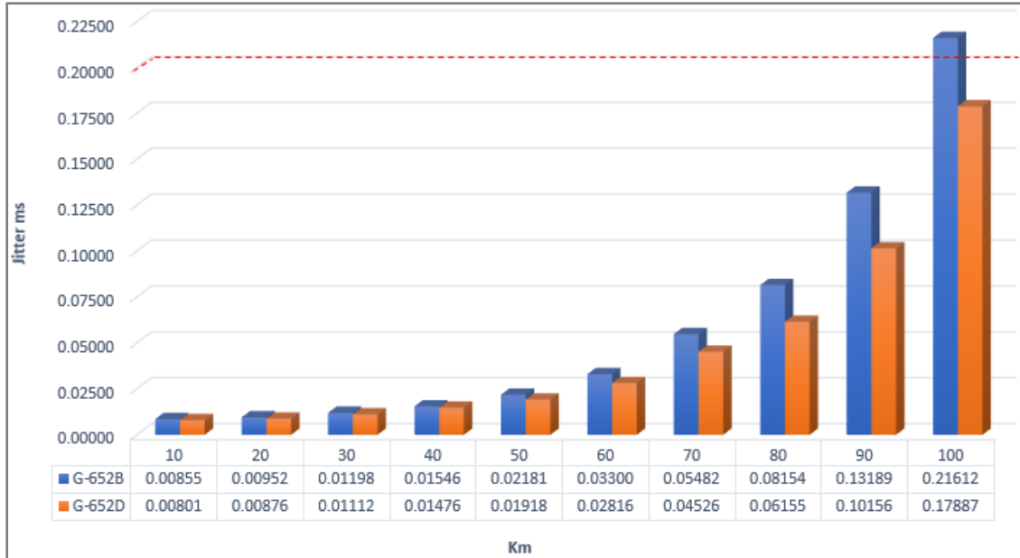
Figura 49. Comparación del parámetro de transmisión JITTER 10 – 100 km
