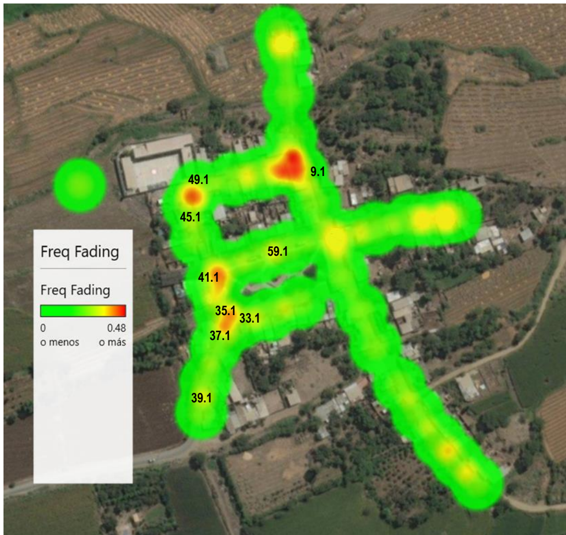
Figura 25: Mapa de calor emplazamientos identificados con mayor desvanecimiento en frecuencia en bandas 1900 MHz a 2600 MHz
