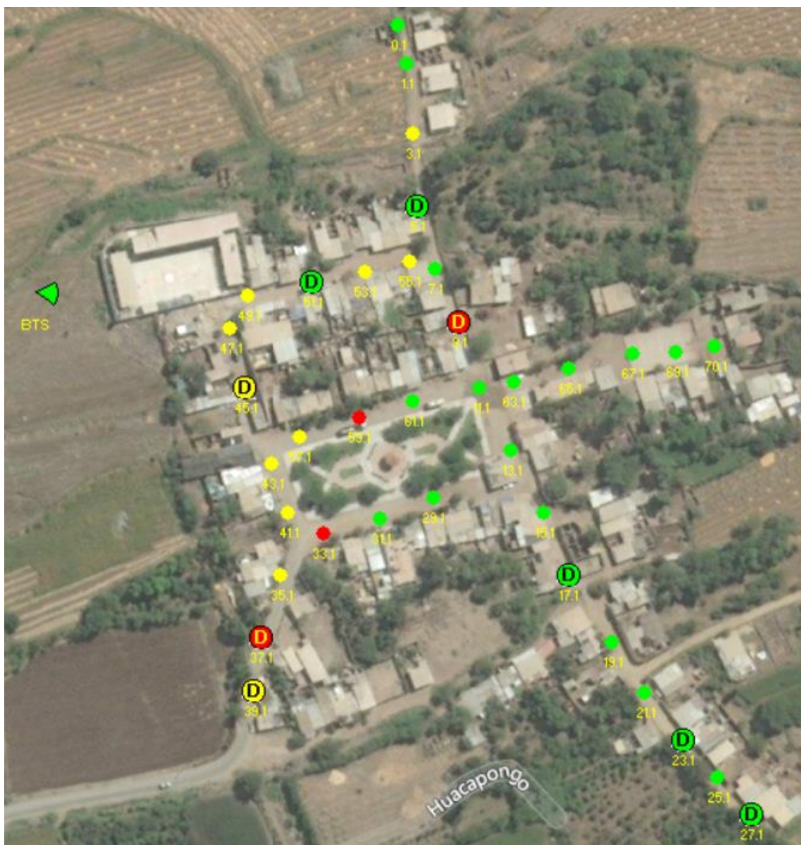
Figura 22: Emplazamientos con mayor desvanecimiento en frecuencia en banda de 2100 MHZ
