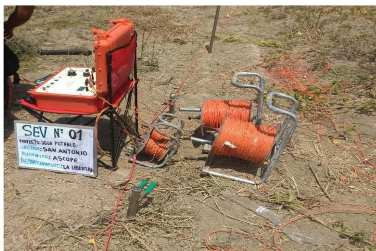
**Figura 08:** Instalación de equipo de prospección geofísica, previo a la ejecución de un Sondeo Eléctrico Vertical–SEV en los alrededores del sector San Antonio-Ascope-La Libertad.
