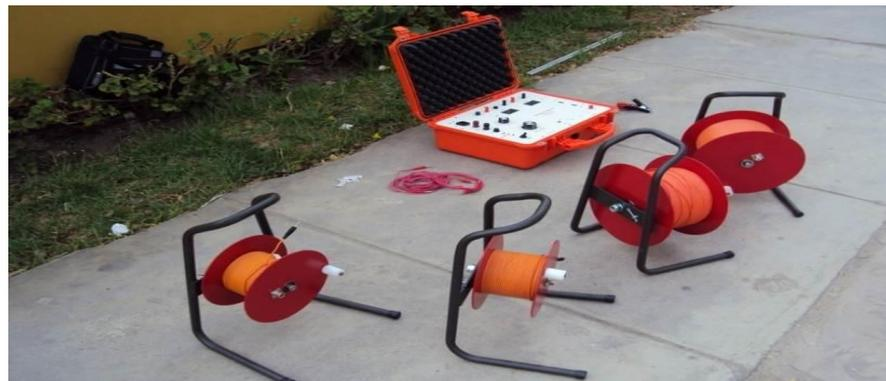
*Georesistivímetro Transmisor–Receptor marca Warg Power, Modelo G 1120, utilizado en la ejecución de Sondeos Eléctricos Verticales–SEVs.*
