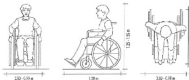
**Figura N° 20. Radio de giro de silla de ruedas**
