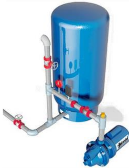
Imagen N° 63: Isometría de Tanque Bomba
