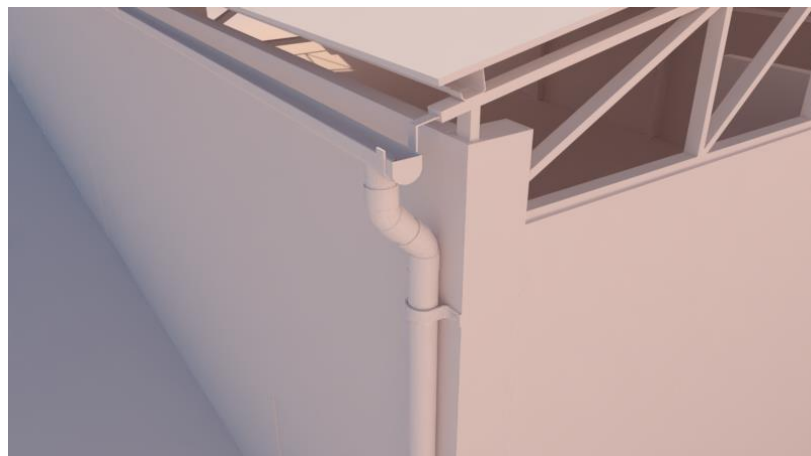
Imagen N° 63. Detalle de ubicación de canaleta a fin de tramo. Fuente: Elaboración propia
