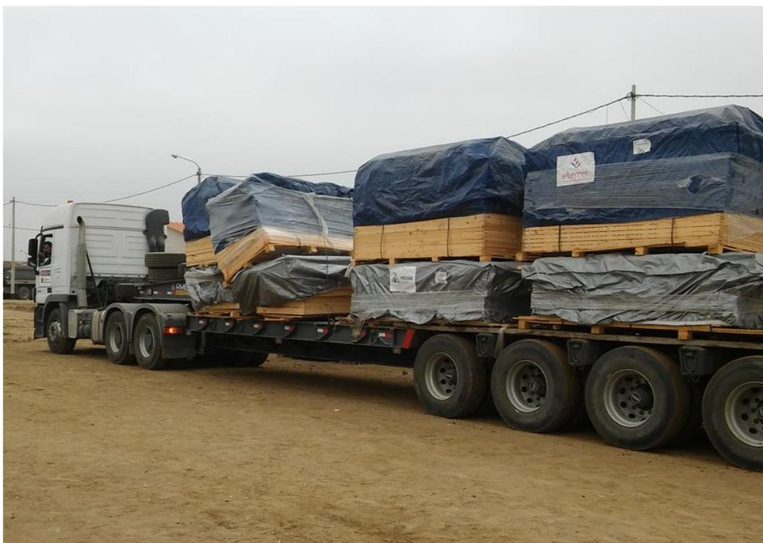
**Transporte de material mediante el vehículo plataforma Cama baja.**
