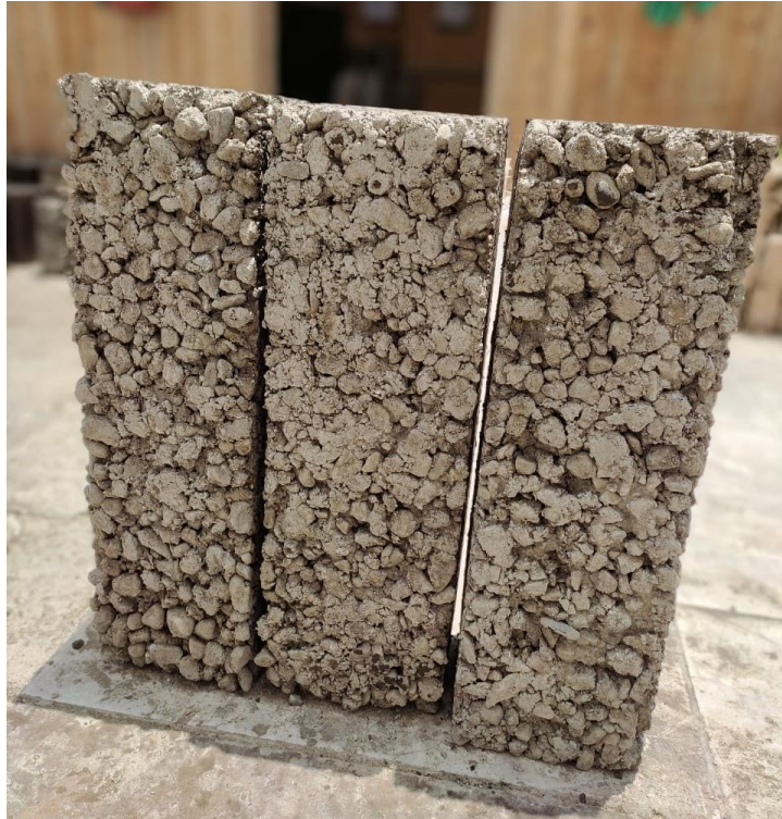
Descripción: Vigas de concreto permeable
