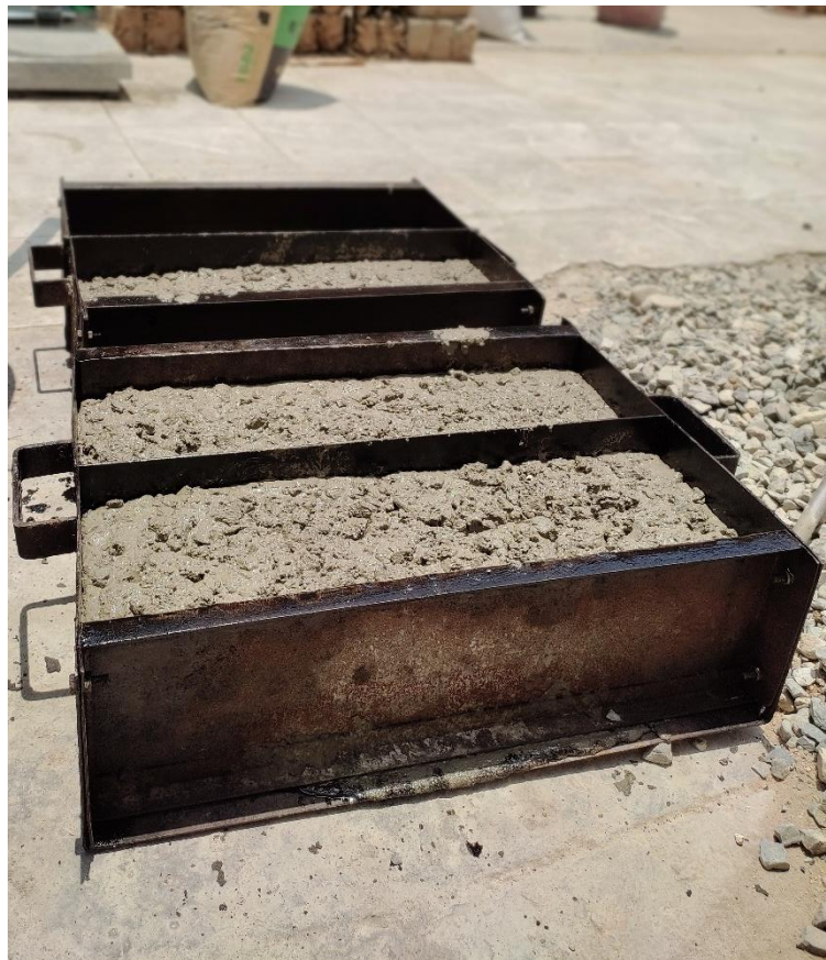
Descripción: Elaboración vigas de concreto patrón
