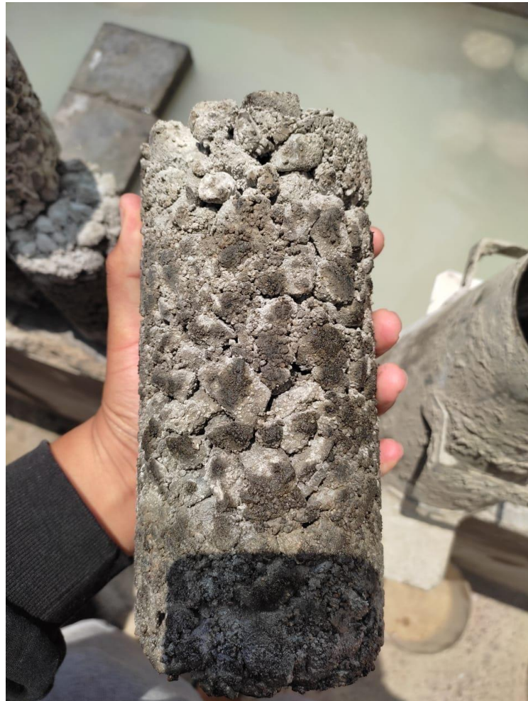
Descripción: Probetas de concreto permeable
