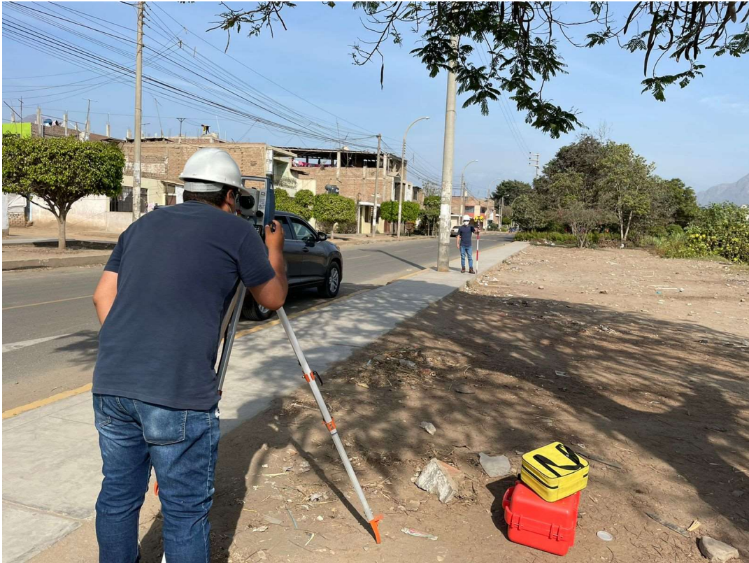
Fotografía 05: Iniciamos el levantamiento topográfico con un BM1.
