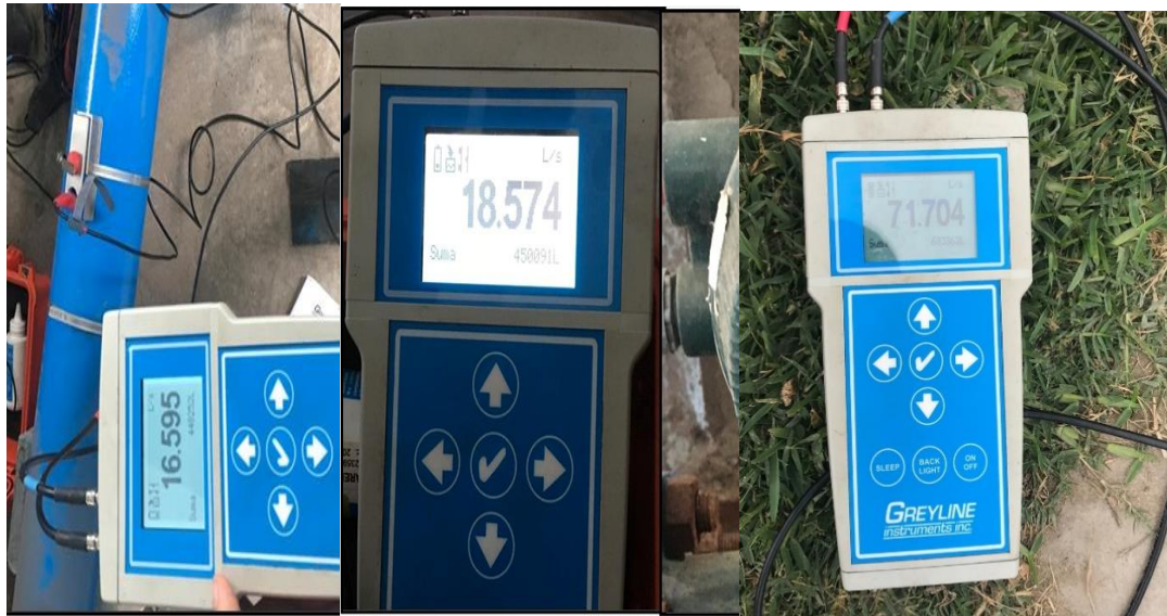
Figura 28. Toma de mediciones de Caudal de Entrega
