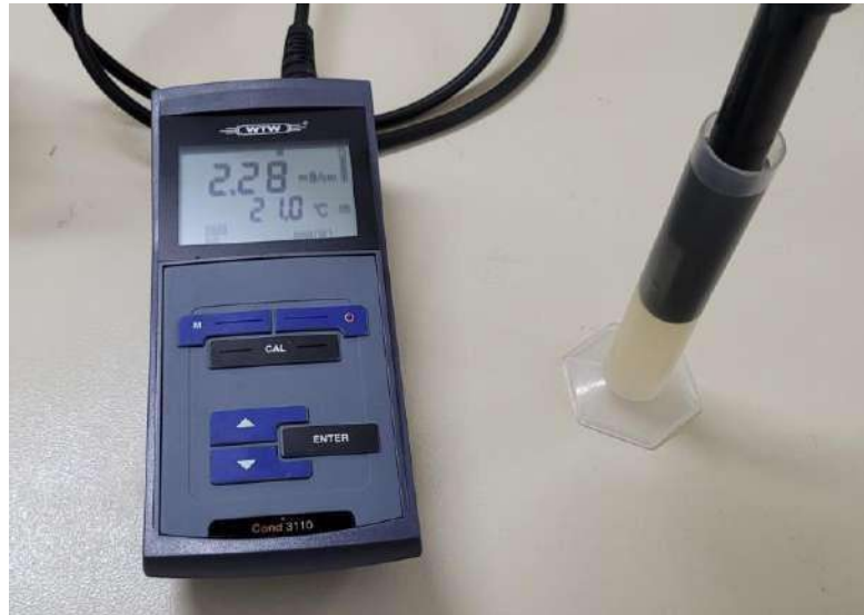
Ilustración 25: Prueba de laboratorio con el sensor Cond 3110
