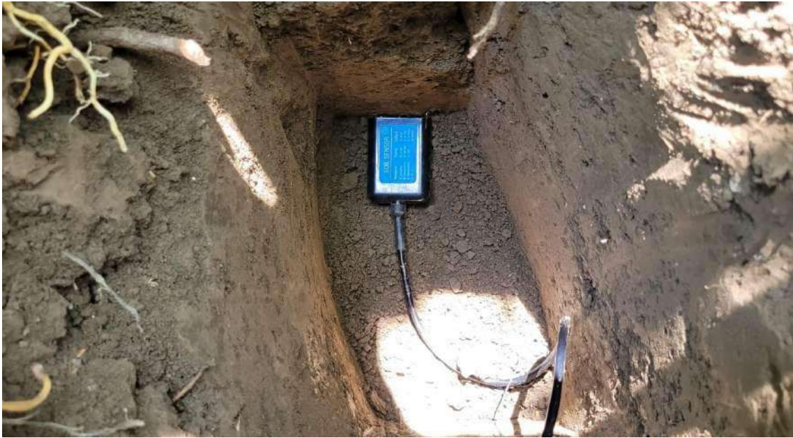
Ilustración 38: Instalación del sensor THC-S
