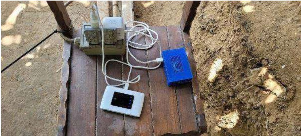
Ilustración 40: Instalación del Raspberry Pi y Wi-Fi
