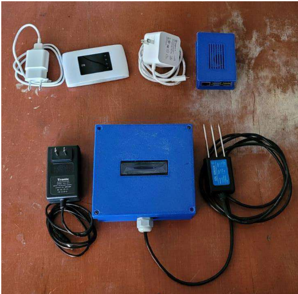
Ilustración 34: Prototipo completo del Sistema de monitoreo de la conductividad eléctrica del suelo
