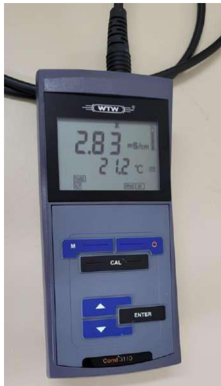
Ilustración 26: Prueba 2 en laboratorio con el sensor Cond 3110
