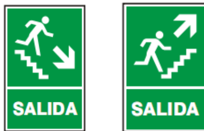
Imagen N°50: Señalización: Ruta de Evacuación Escalera
