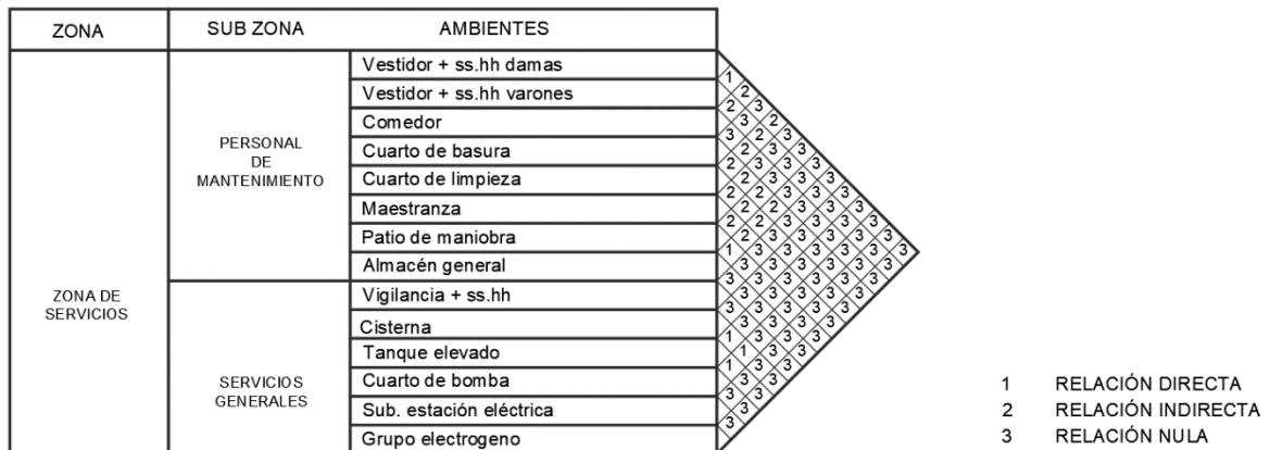
Imagen N°83. Diagrama de relaciones funcionales de la Zona de Servicios y Extensión educativa
