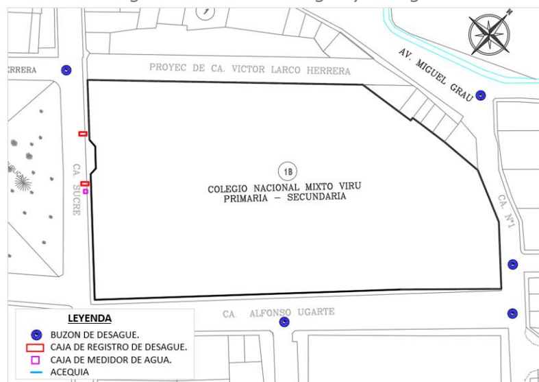
Imagen N°41. Plano de agua y desagüe
