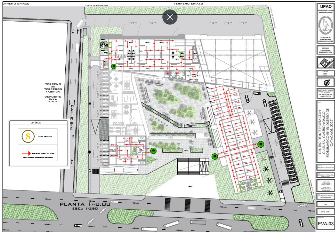
Ilustración 114: Ruta de evacuación - Planta +/-0.00m
