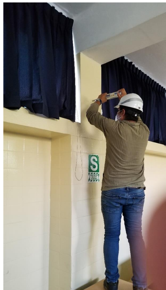
FIGURA 30: Ensayo esclerométrico en columnas del bloque "A" en el 1er piso.
