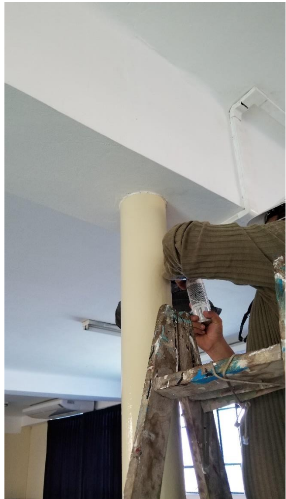
FIGURA 34: Ensayo esclerométrico en vigas del bloque "A" en el 2do piso.
