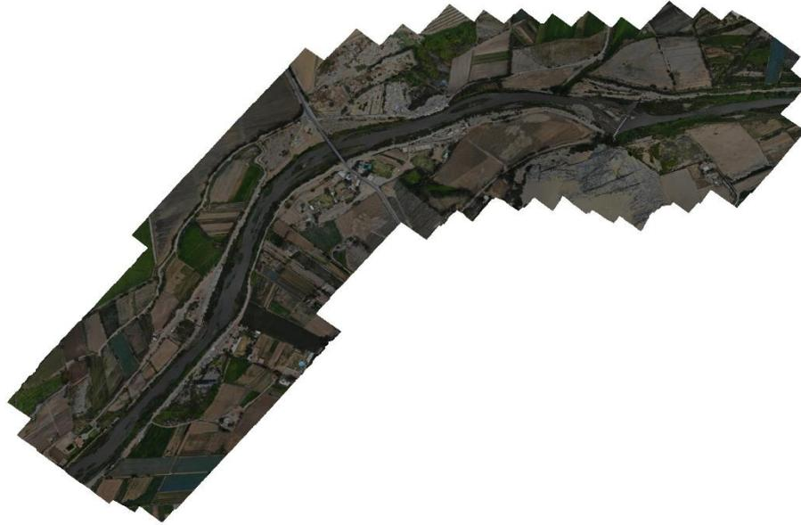
**Fotografía 5. Vista en Planta–Fotografía ortogonal del terreno levantado mediante dron**
