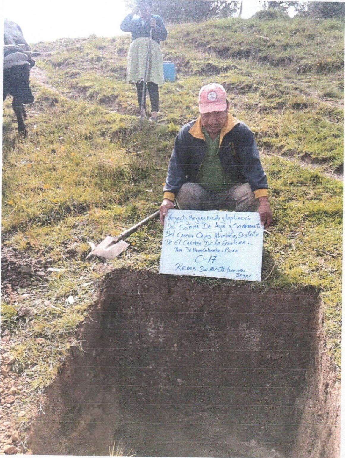
Perforación de la Calicata N° 17, ubicada en REDES DE DISTRIBUCIÓN.
