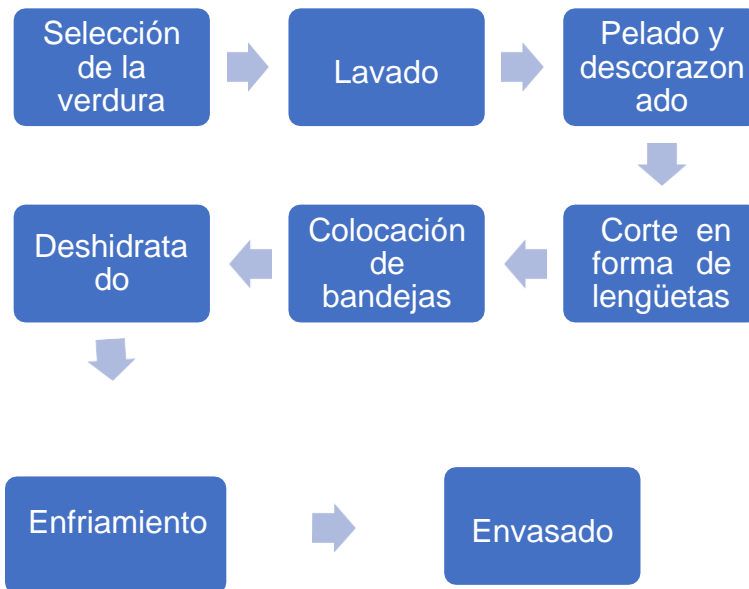
Figura 18 Diagrama de proceso de verdura deshidratada.
