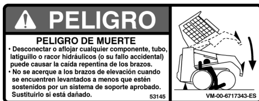
Ilustración 2: Etiqueta de advertencia de peligro de muerte
