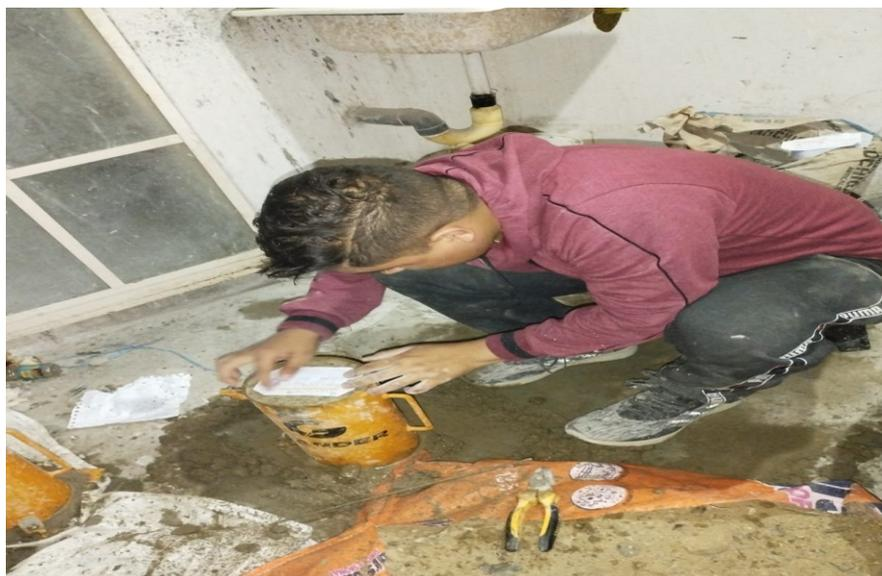
Nota: Luego de terminar de llenar las 3 capas y poner los tornillos de manera más segura, se procede a marcar en una hoja pequeña poniéndole en la probeta para poder identificar
