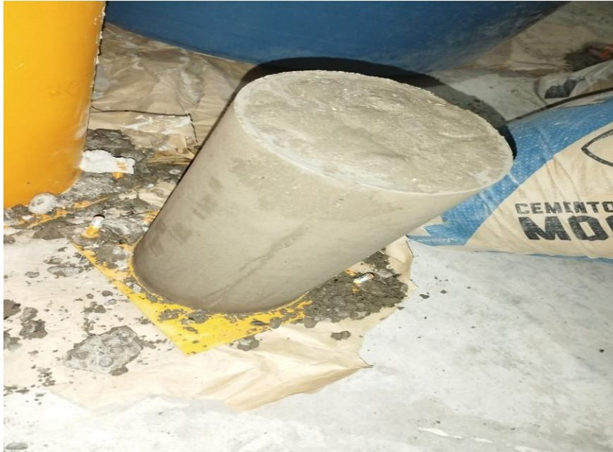
Nota: Luego de sacar los moldes tiene que quedar toda la probeta completa.
