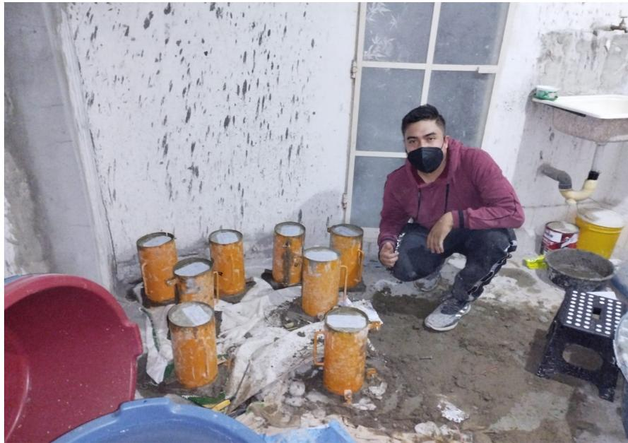
Nota: Luego de terminar con la primera probeta se procede a terminar todos los moldes restantes para después dejarlos reposar por 24 horas.
