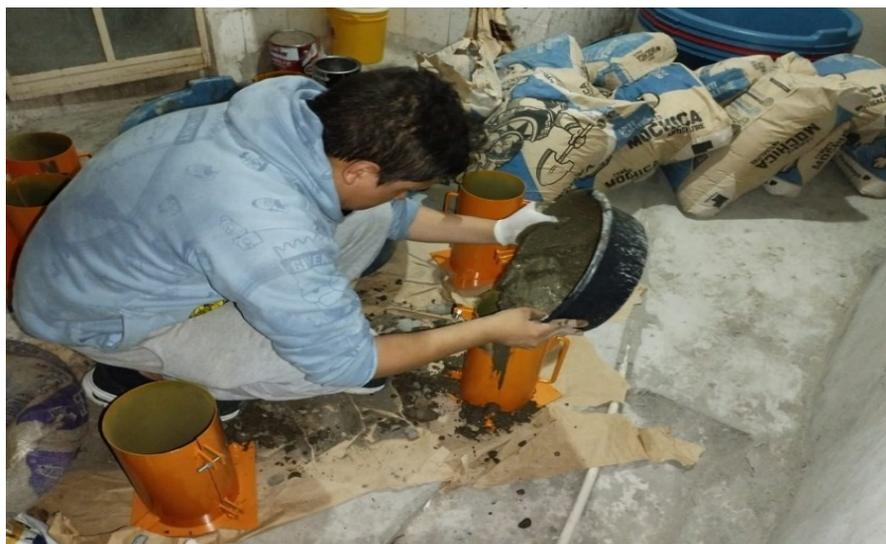
Nota: Una vez termina la mezcla 1:10 con todo lo mencionado se procede a vaciar a los moldes para las muestras cilíndricas.
