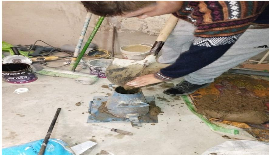
Nota: Vaciamiento del concreto al molde metálico, se tendrá en cuenta que será vaciado en 3 partes.
