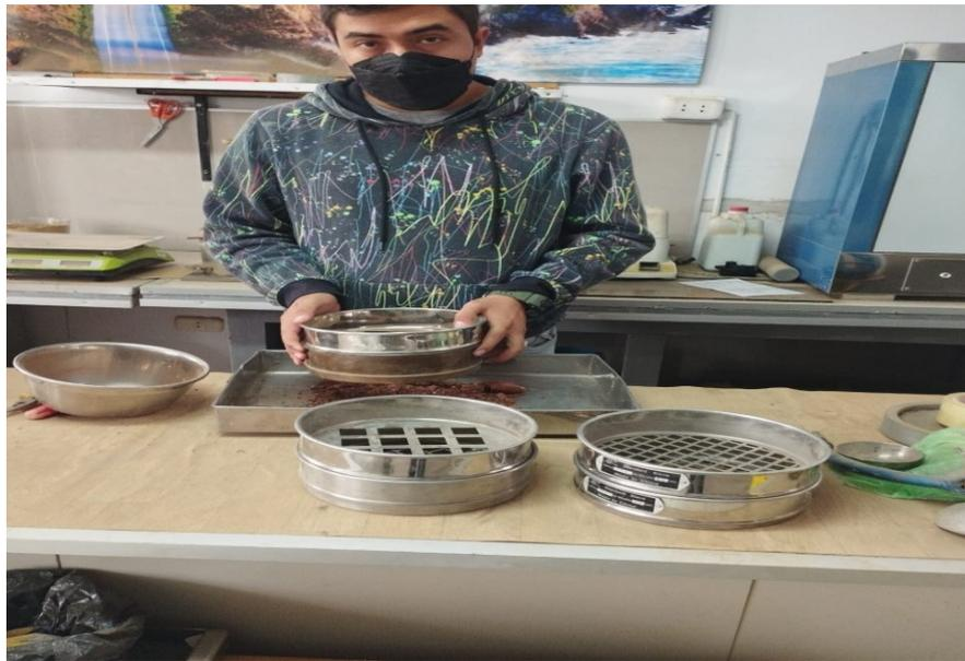
**Nota:** Se procede a mover el tamiz según tamaño destinado otorgado para el laboratorio de izquierda a derecha y de abajo hacia arriba hasta que caiga todo lo necesario para completar el tamaño indicado del tamiz.
