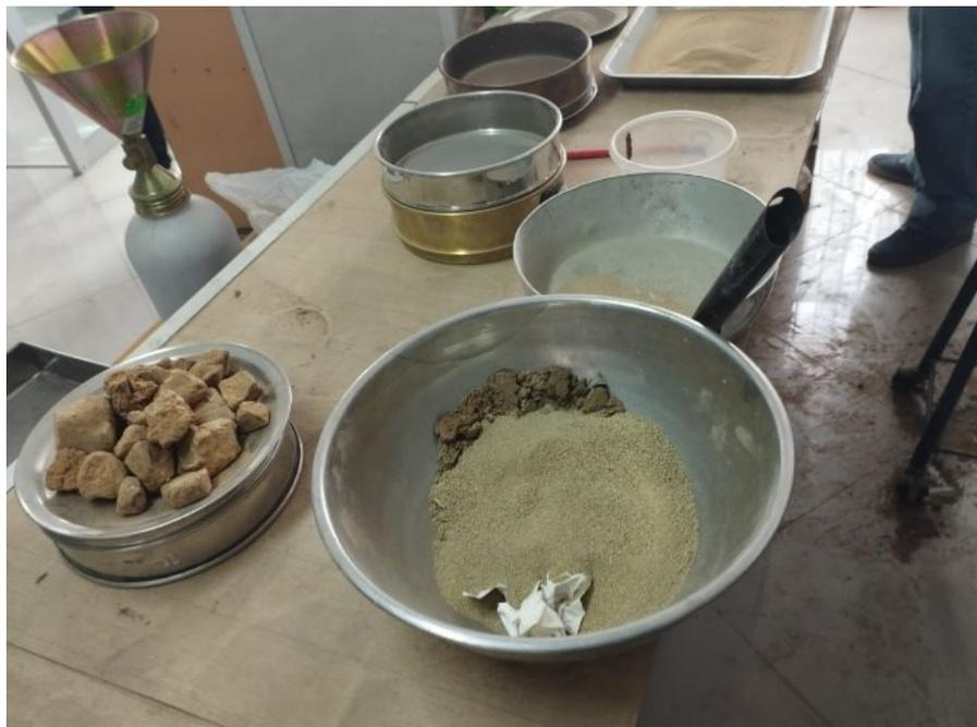
Nota: Aquí se observa que según el proceso de secado en horno se ha obtenido el material con distinta forma y separación de tamaños de agregado.
