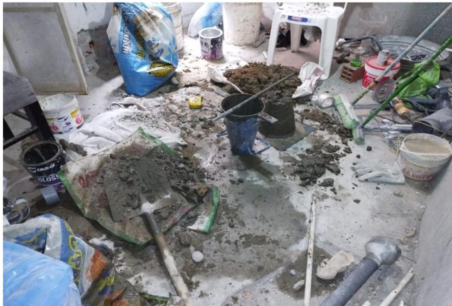
Nota: Luego de pasar la varilla y dejar todo raso acorde al molde la mezcla, se procede a retirar el molde metálico.
