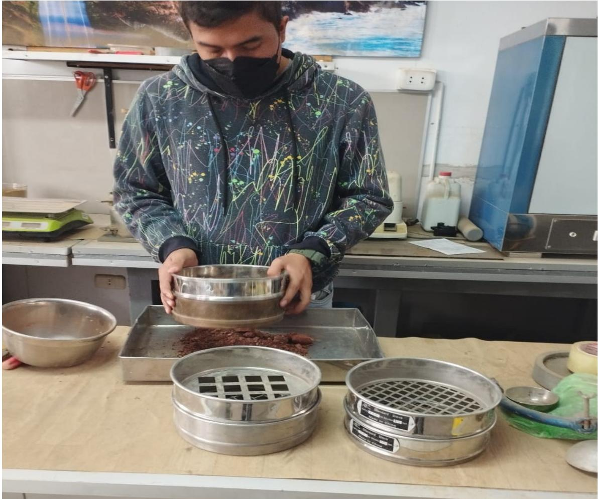
Nota: Se demuestran el proceso del ensayo Granulométrico, como en este caso luego del proceso de cuarteo y secado de muestra se da, la agitación de tamices, Buscando así obtener las muestras que pasan por cada uno de ellos para ver así el grado de finura del material y los tamaños de sus partículas restantes.
