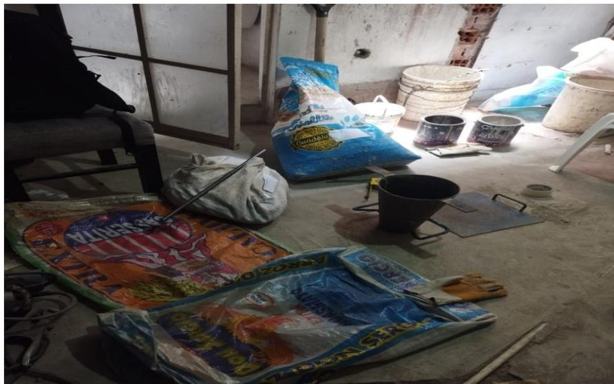
Nota: Se presenta los agregados, el molde y base metálico, la barra de compactación, la huincha, sacos que servirán como base para hacer el concreto con medida específica en mezcla 1:10 y latas que ayudarán para dicho propósito.
