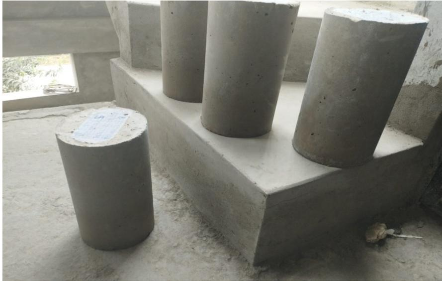
Nota: Después de estar fuera de moldes se procede a colocarlas para el proceso de fraguado en las tinas luego de que cumplan las 24 horas se procede a sacarlas y están listas para llevarlas al laboratorio.
