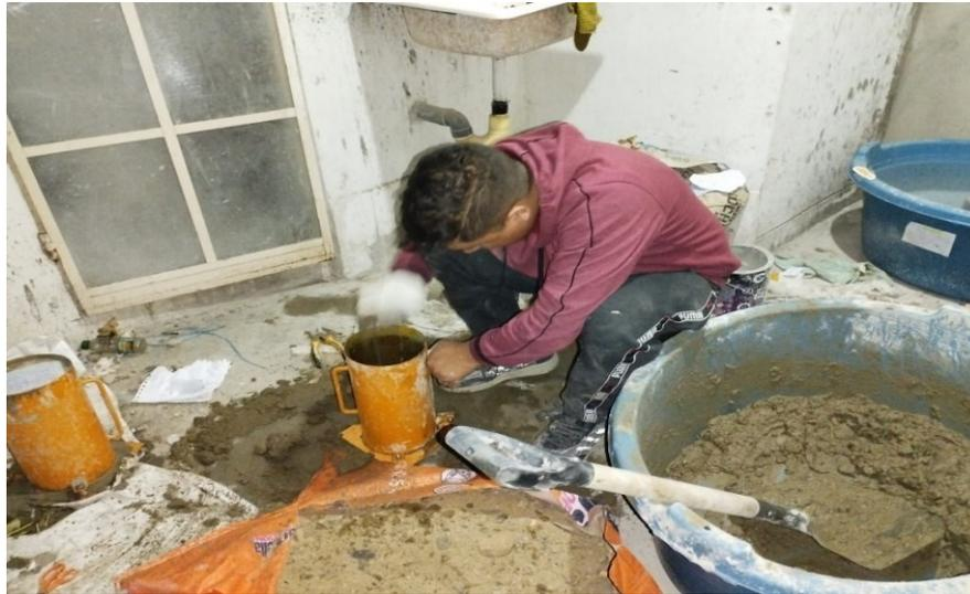
Nota: Después de terminar de hacer la mezcla se procede a llenar los moldes en función a las 3 capas se compacta una por una con 15 golpes.
