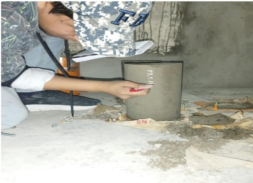
Nota: Luego de retirar de todo el molde se procede a marcar para poder distinguirlos frente a las demás probetas hechas.
