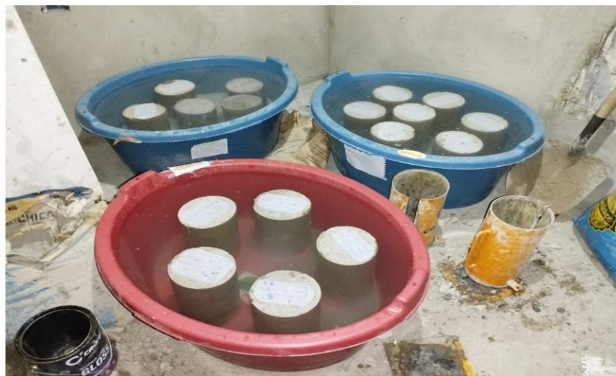
Nota: Luego las probetas se dejan 24 horas dentro de las tinas con agua llenadas por encima de su estatura
