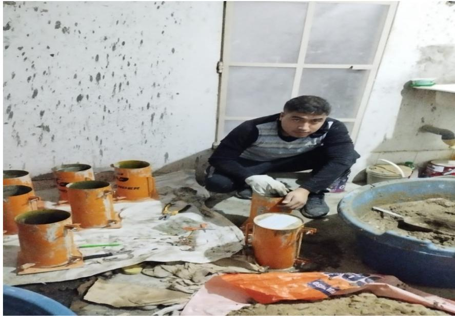
Nota: Una vez terminado las capas en la parte final se pone un marcador de una hojita para saber distinguir cada probeta.
