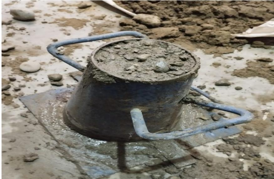
Nota: Se realiza los mismos procedimientos anterior hasta llenar las 3 capas dentro del molde metálico.
