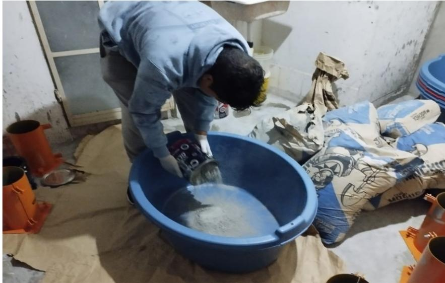
Nota: Procedimiento para las 80 probetas debido a mi espacio reducido donde las realice fueron hechas en 4 partes de 20 tomando así las primeras 20 su proceso, primero se mide la lata la cantidad de cemento que se colocara para la mezcla 1:10 luego se procede a vaciarla en la tina, lugar donde se realizara la mezcla.
