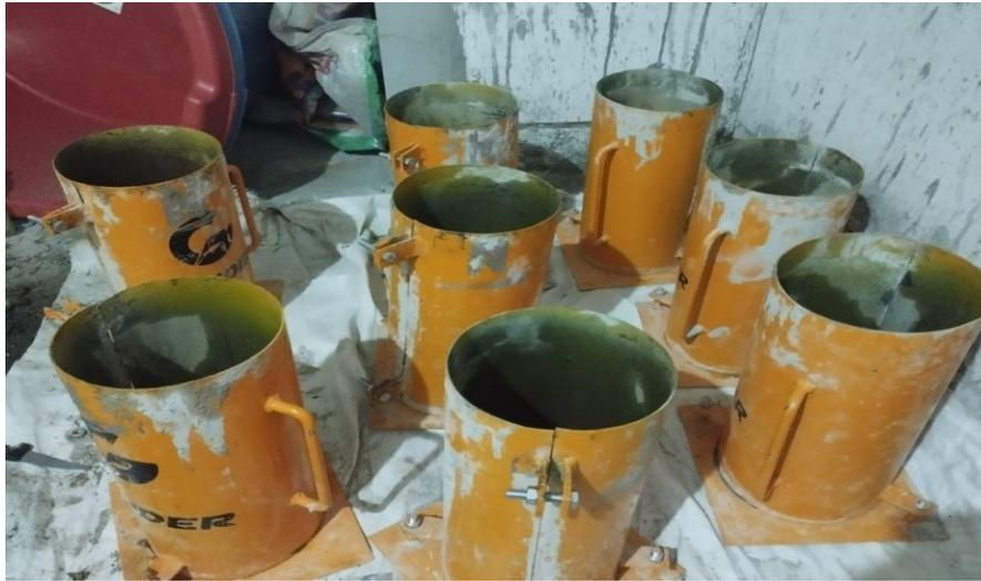
Nota: Para el segundo tramo de las 20 probetas ya teniendo en cuenta los procesos necesarios se comienza a realizar tal labor, Antes de empezar se lavan todos los moldes ya utilizados y luego de ello se soba con un trapo de aceite cada molde para así quede listo.
