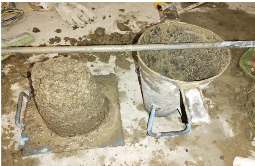
Nota: luego de haber pasado 5 minutos, se procede a retirar el molde metálico para luego visualizar el asentamiento del concreto.
