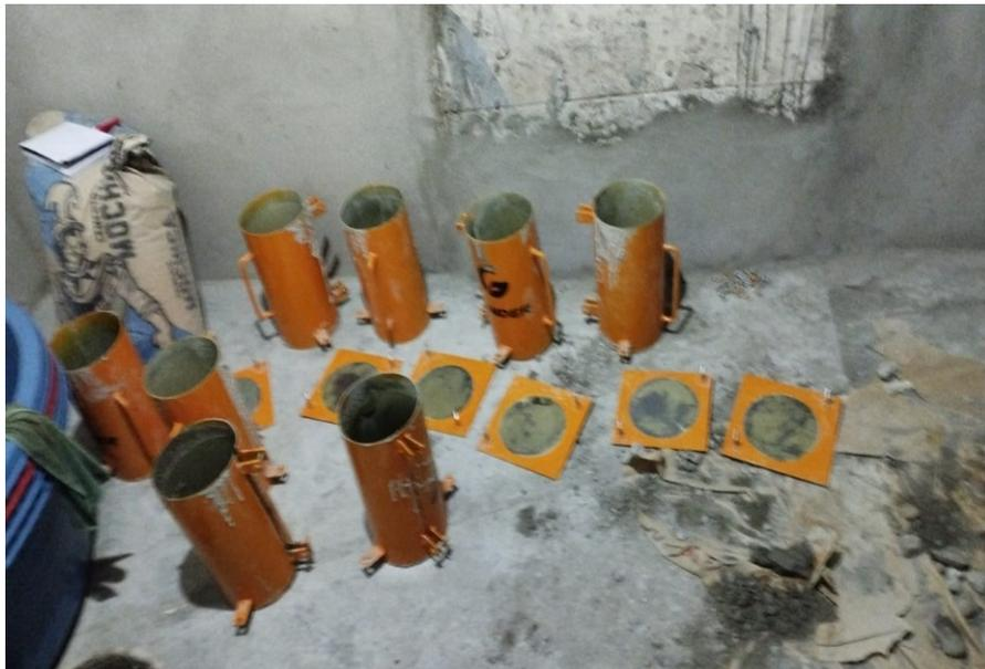
Nota: Materiales para el ensayo de rotura de muestras cilíndricas hechas con hormigón del río Chilete cantera margarita y en comparación con la cantera Bauner S.A Trujillo son: 8 probetas, cemento 1 y tinas grandes.
