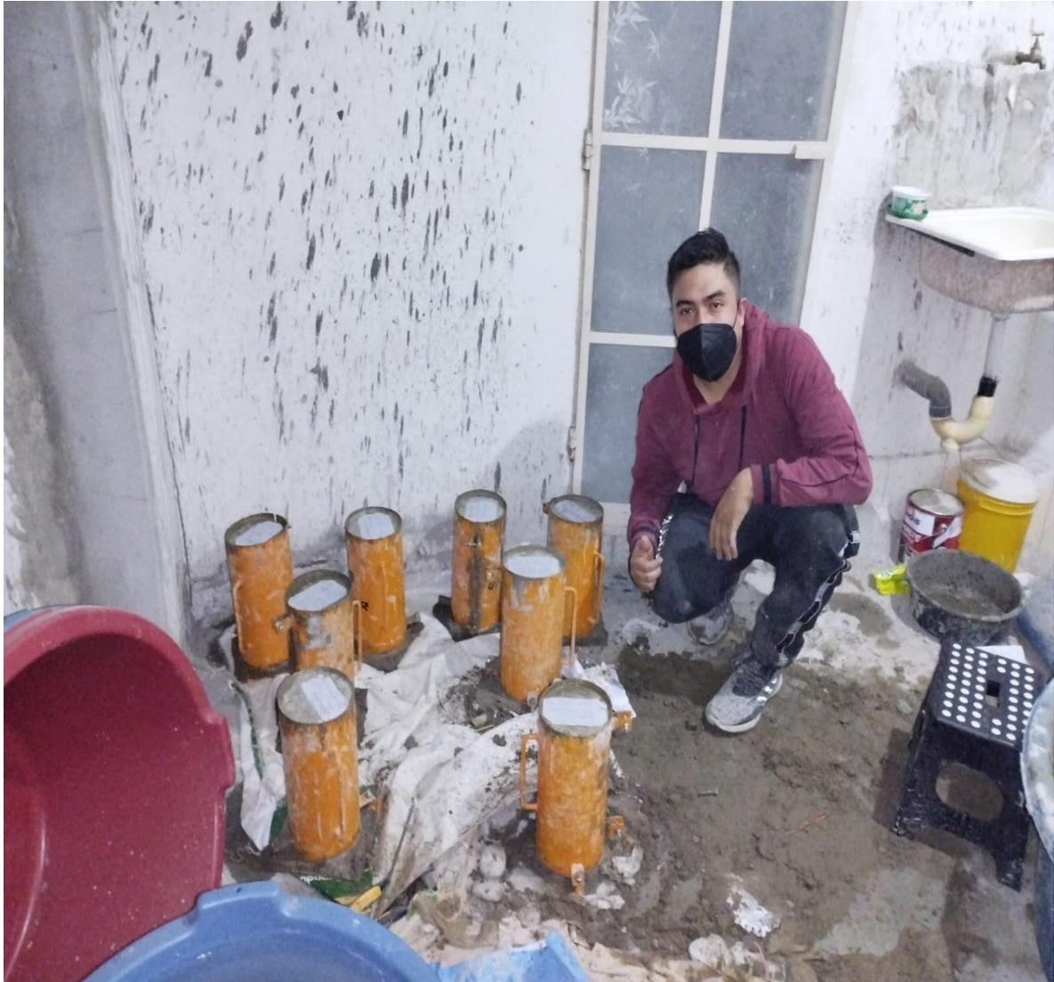
Nota: Aquí se observa la elaboración concluida de la construcción de las muestras cilíndricas, teniendo en consideración sus procesos de elaboración adecuado, sus etiquetas de identificación y su mezcla con el hormigón específico. Ello es solo una parte de todas las realizadas.
