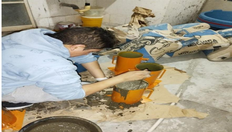
Nota: Lo conveniente del llenado se daría en tres partes donde luego de llenar una tercera parte del molde se procede a compactar con una varilla delgada acorde al molde con 15 golpes por cada capa llenada y finalmente se endurecen los tornillos ya puestos en cada molde.
