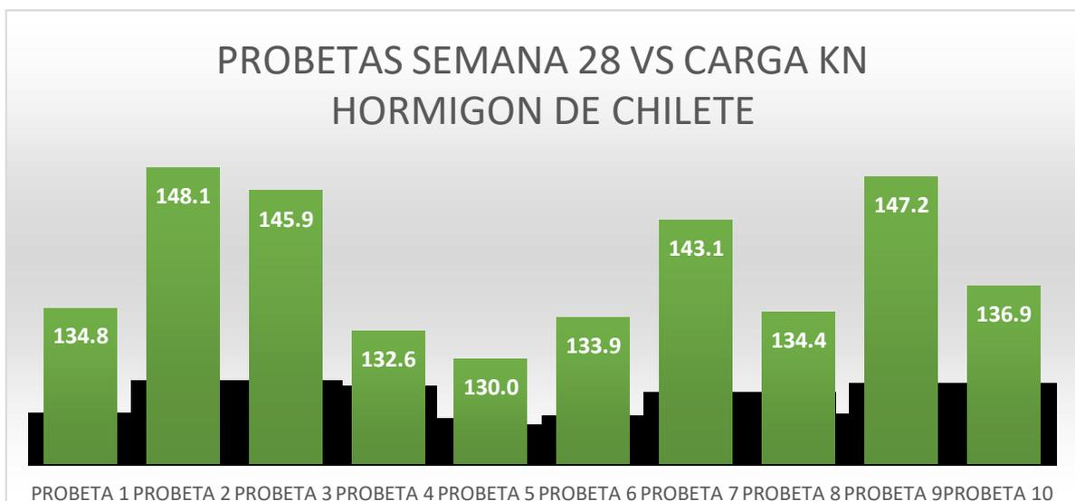
Nota: Según el grafico de barras se muestra el resultado de carga de las probetas 31 a 40 en estudio.
