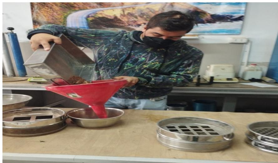
**Nota:** El agregado que se obtiene por medio de los tamices se queda en la fuente y se pasa por el cono para que llegue al tazón metálico para luego se proceda a pesar.
