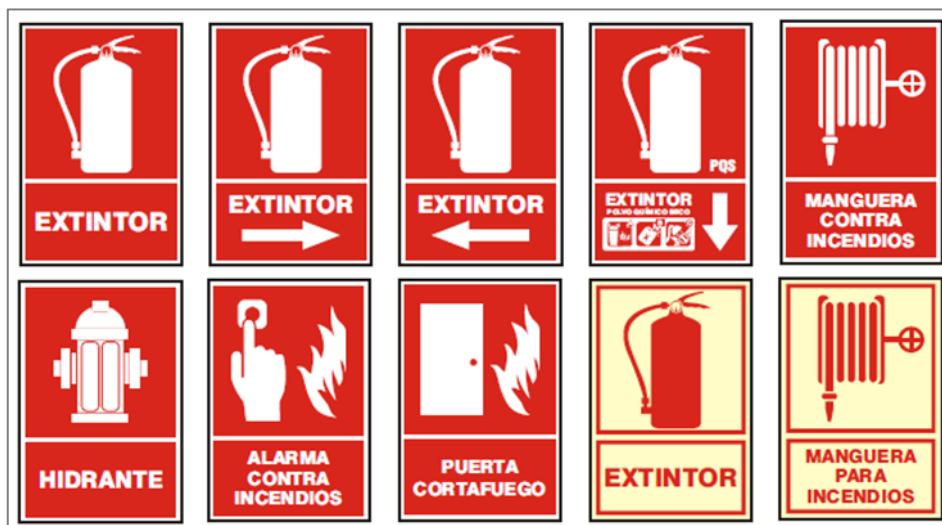
Figura 60 Señalización de equipos de prevención y protección contra incendios.
