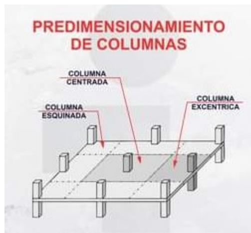
Figura N°156: Tipos de columnas según ubicación
