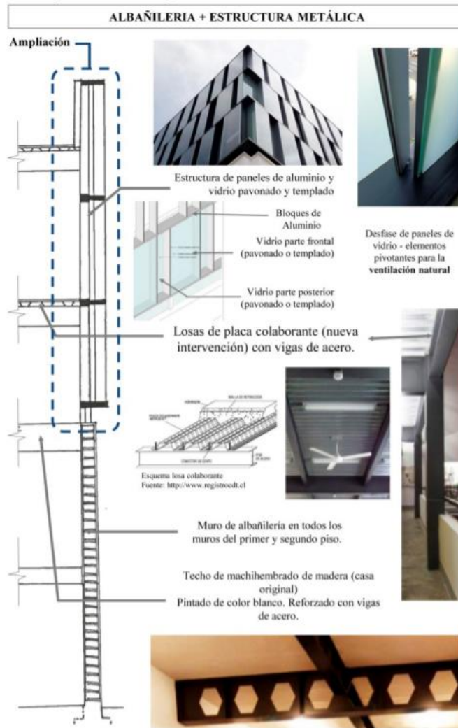
Gráfico 78: Albañilería y estructura metálica Fuente: Escuela de artes visuales
