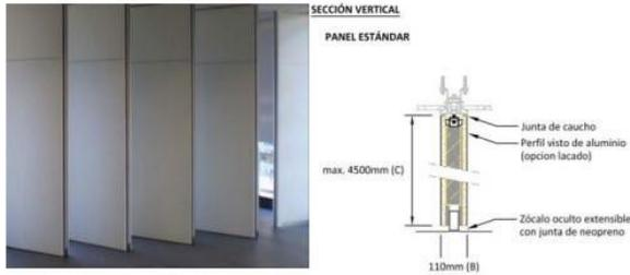
Figura:107: Panel acústico móvil. Figura:108: Detalle- Panel acústico móvil.
