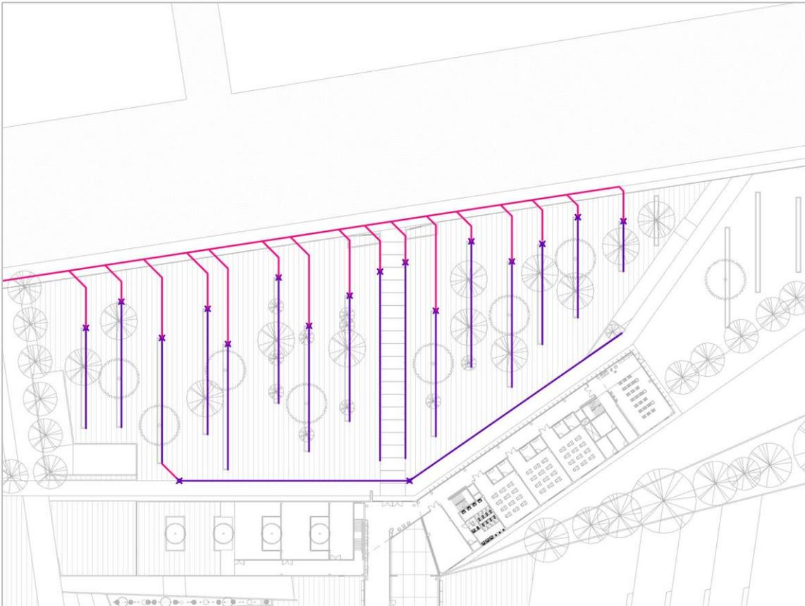
*Nota.* La red de drenaje pluvial externa en las plazas esta compuesta por las canaletas con rejillas encastrables (morado) que unen a tuberías (magenta)
