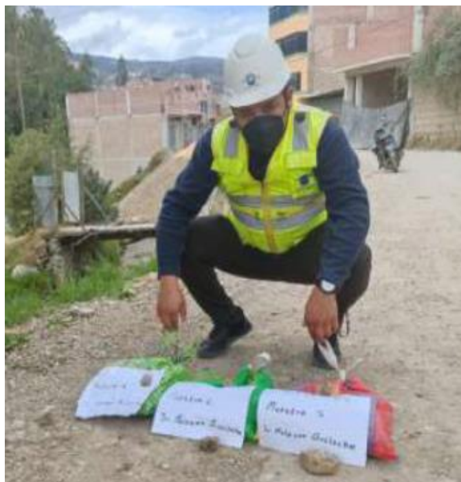
Fotografía 4. Muestreo de las calicatas realizadas.
