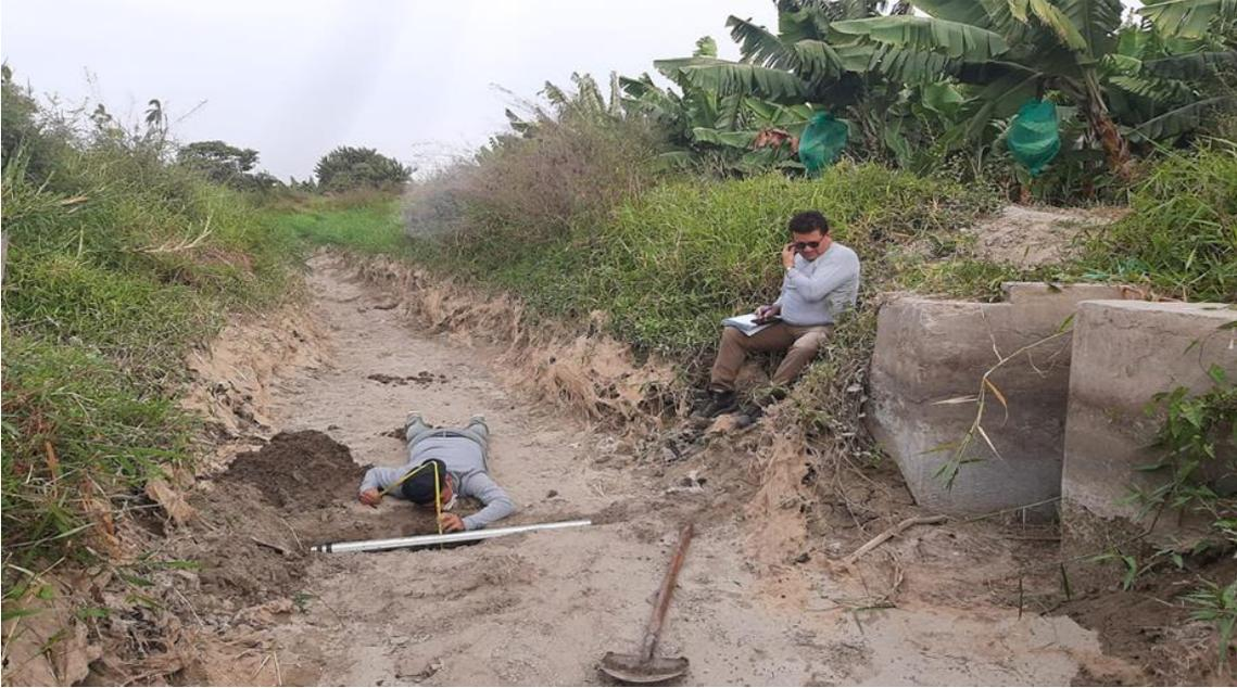
*Fotografía 9. Se aprecia el ensayo del método de Porchet*
