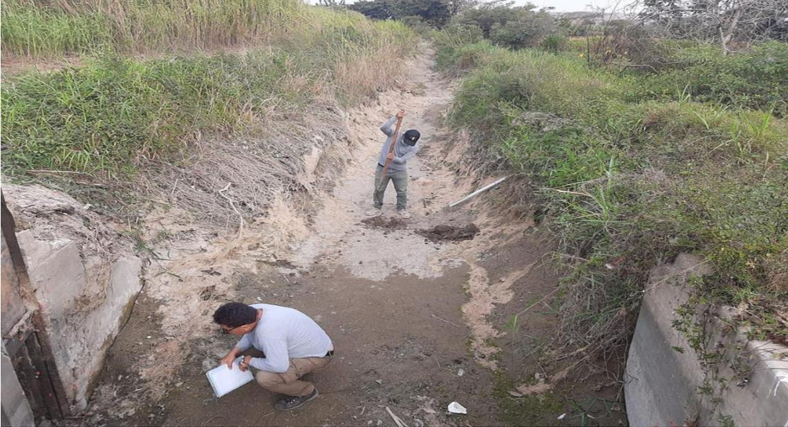
*Fotografía 11. Se aprecia el ensayo de Método de Porchet en el punto final del tramo*
