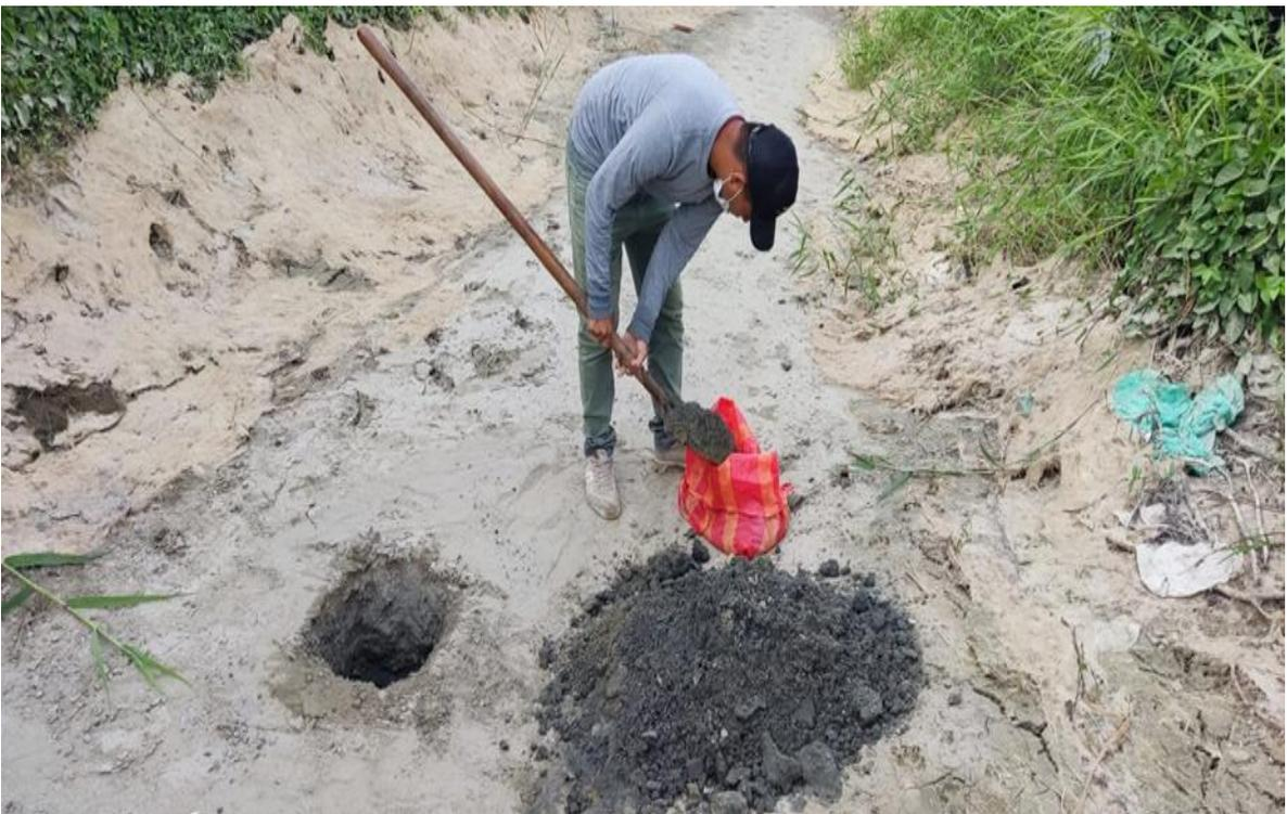
*Fotografía 8. se aprecia el Recojo de Muestras para estudio de mecánica de suelos.*
