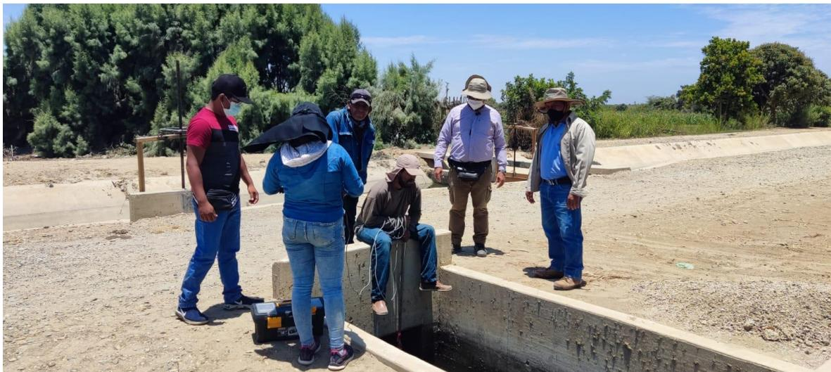
*Fotografía 13. Se aprecia el ensayo de correntómetro en el punto inicial Canal Santa Elena*
