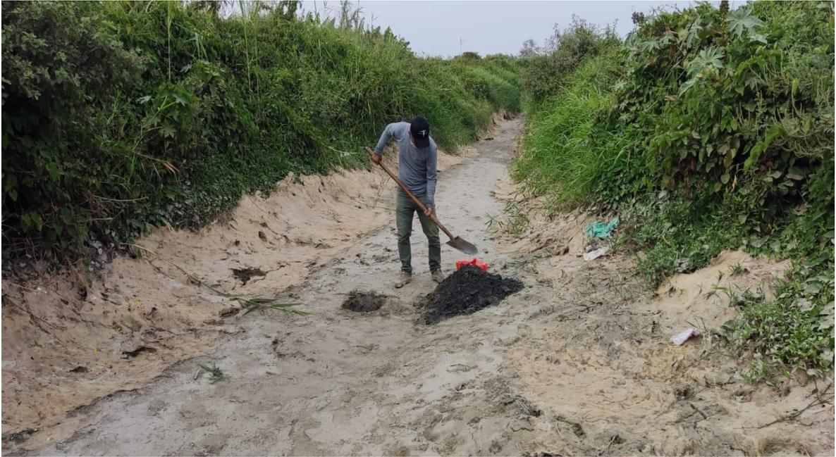
*Fotografía 7. Se aprecia el Recojo de Muestras para estudio de mecánica de suelos.*
