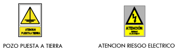
Figura 46: Señaléticas de riesgo eléctrico
