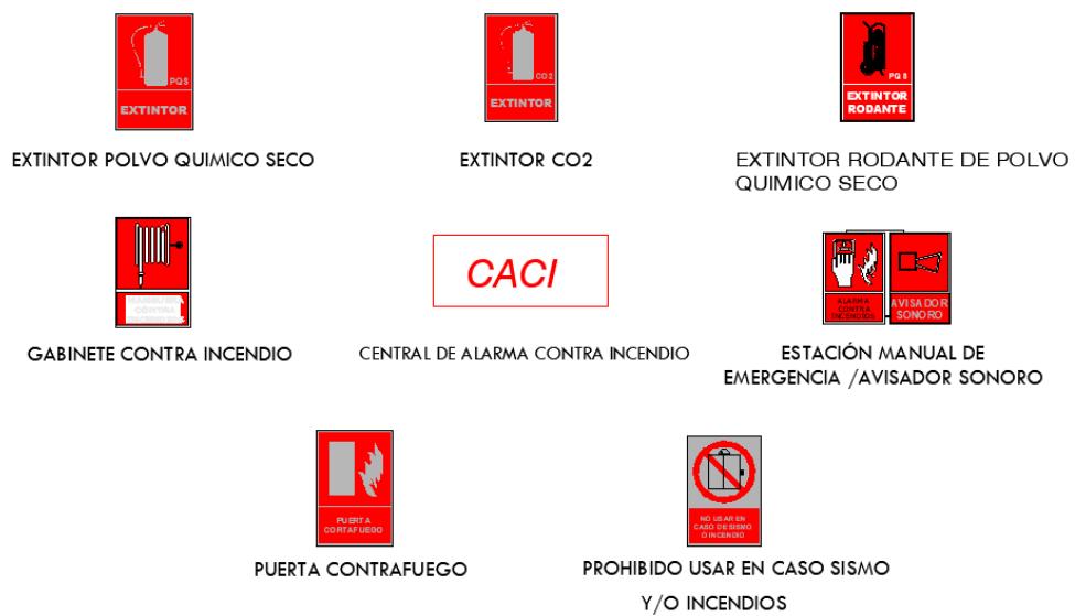
Figura 45: Señaléticas de seguridad en caso de incendio
