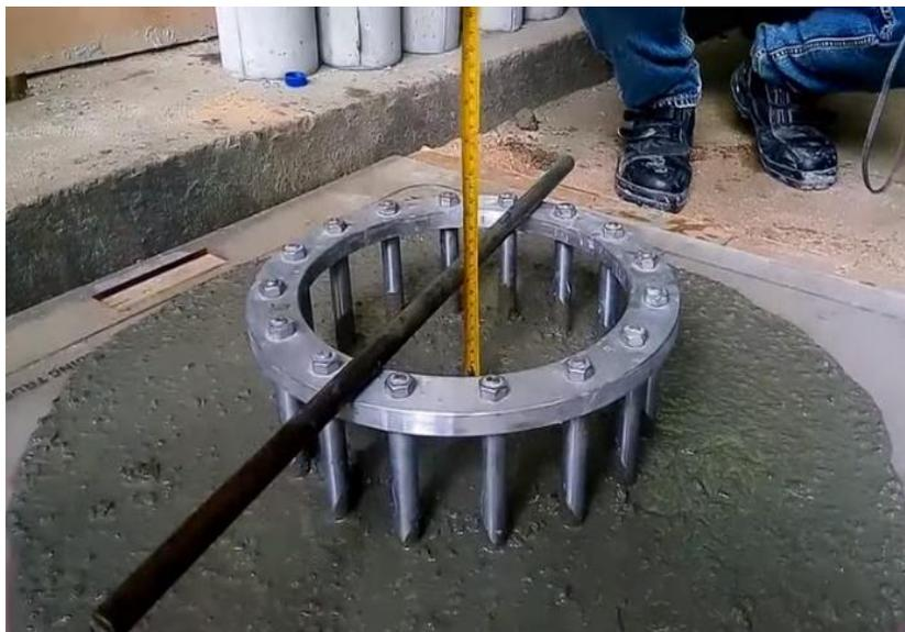
Foto N°04. Ensayo del Anillo J
