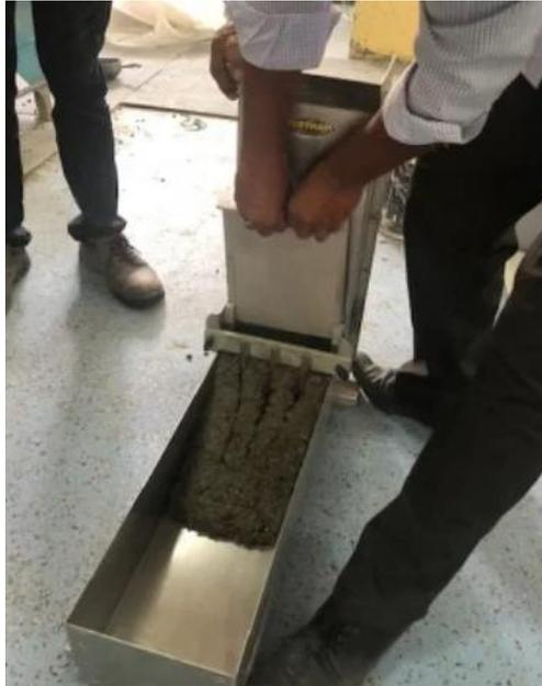
Foto N° 05. Ensayo de la Caja L
