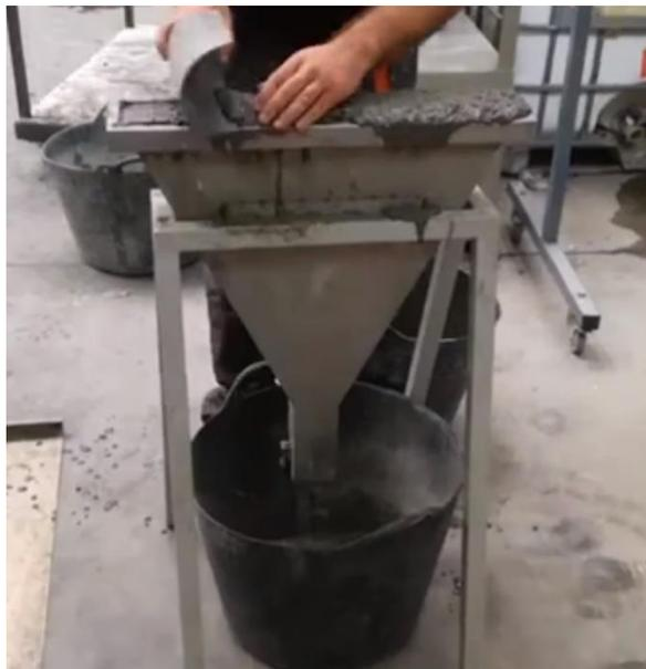
Foto N° 06. Ensayo del embudo V
