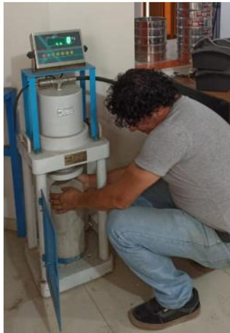
Foto N° 08 Ensayo de compresión axial.
