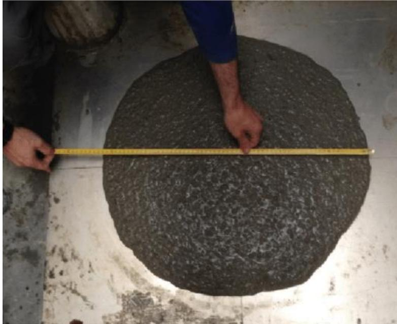
Foto N°03. Medición de  $D_f$ , en ensayo de Extensibilidad.
