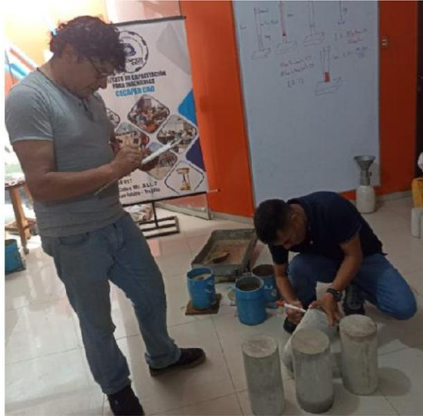
Foto N° 07. Codificación de Probetas.
