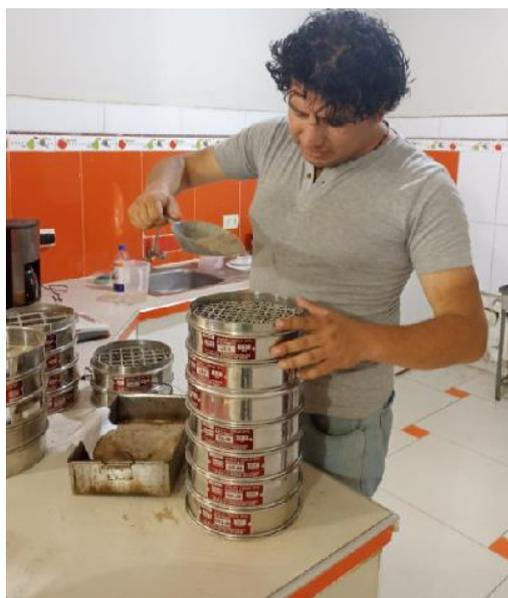
Foto N° 01. Análisis granulométrico de los agregados
